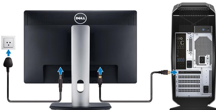
**i** ANMERKUNG: Der DisplayPort auf der Rückseite des Computers verfügt über eine Abdeckung. Zum Anschluss des Bildschirms an die separate Grafikkarte des Computers.
