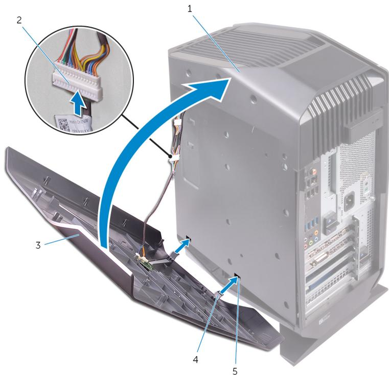
图 6: 连接照明电缆
