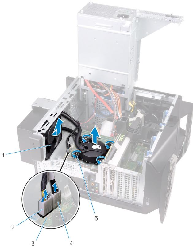
图 21: 卸下处理器冷却部件
