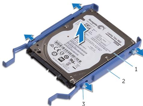
图 16: 从硬盘驱动器托盘中卸下硬盘驱动器
