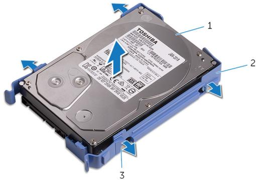
图 14: 从硬盘驱动器支架卸下硬盘驱动器
