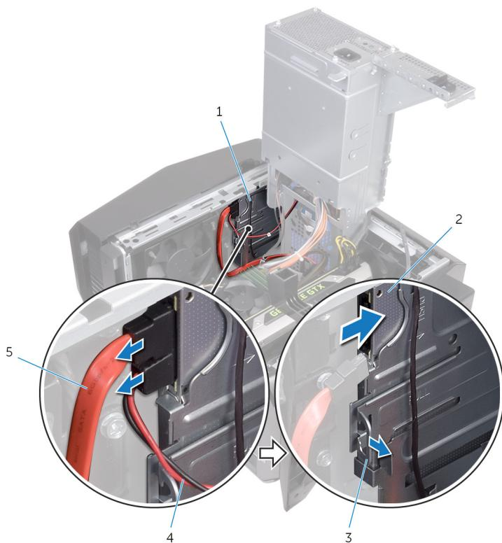
图 41: 断开连接电源电缆和数据电缆
