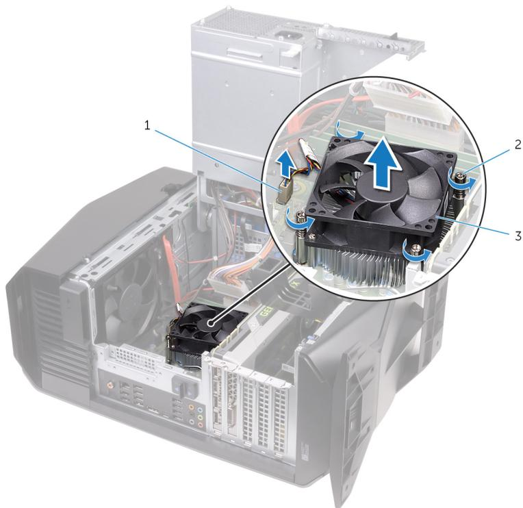
图 30: 卸下处理器风扇和散热器部件
