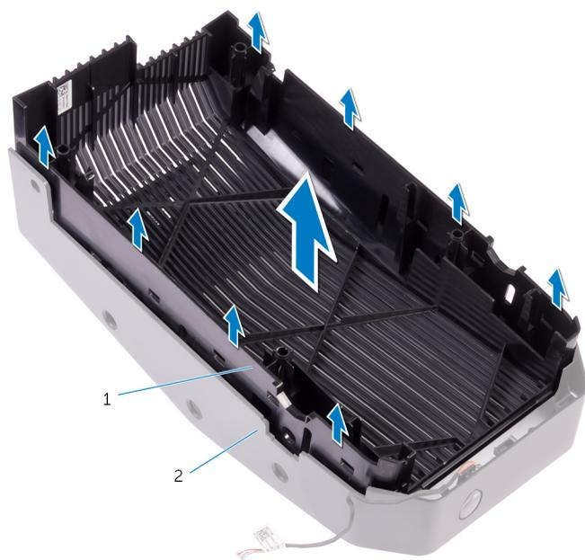
图 11: 从顶部挡板提起顶盖
