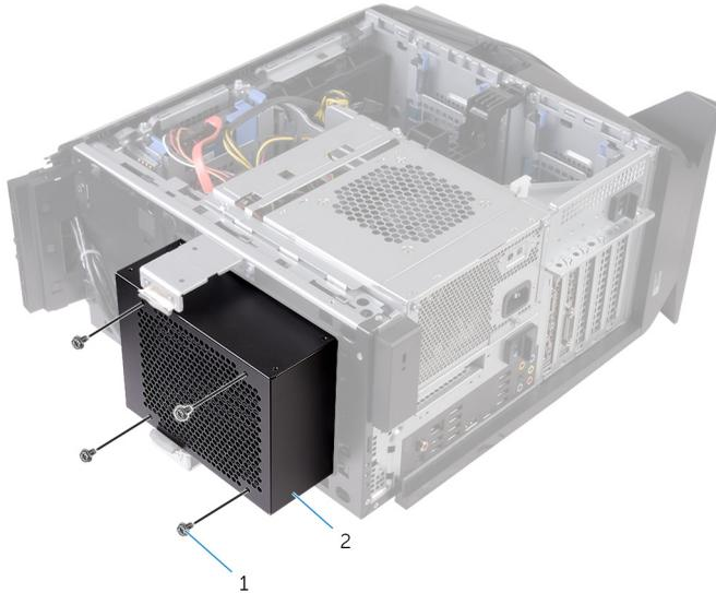
图 19: 卸下处理器冷却部件
