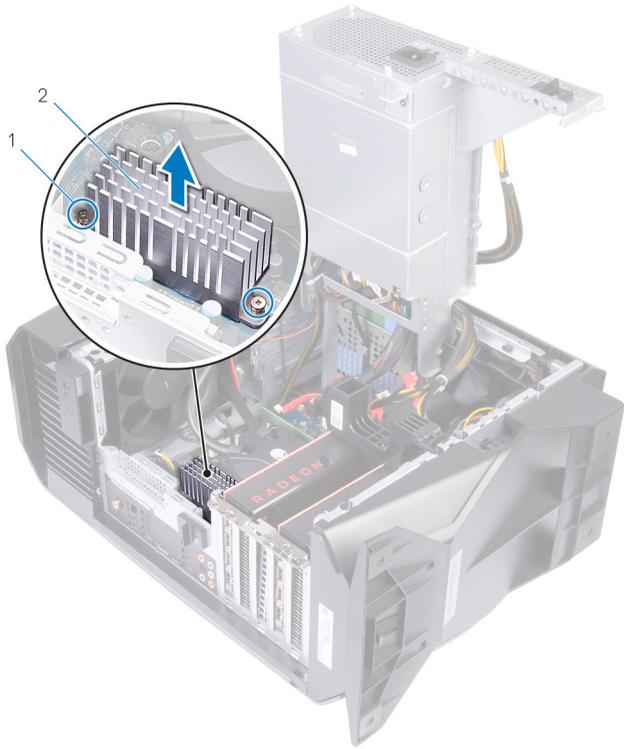
图 29: 卸下 VR 散热器
