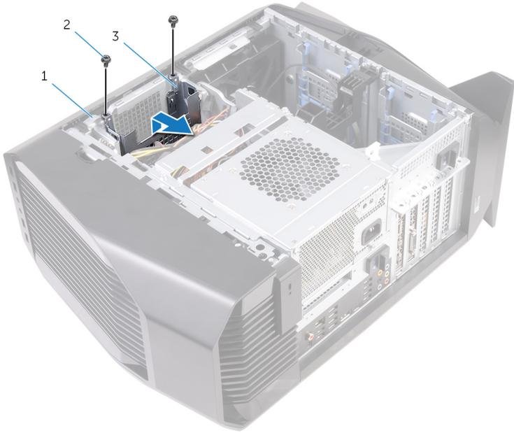
图 17: 卸下硬盘驱动器固定框架
