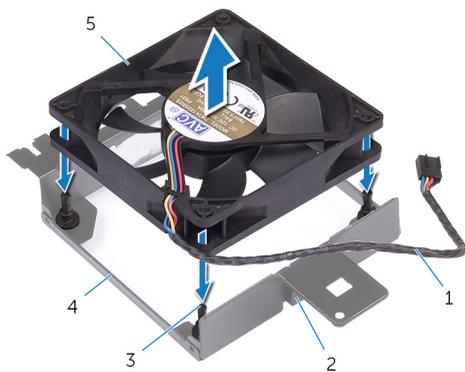
图 40: 卸下机箱顶部风扇
