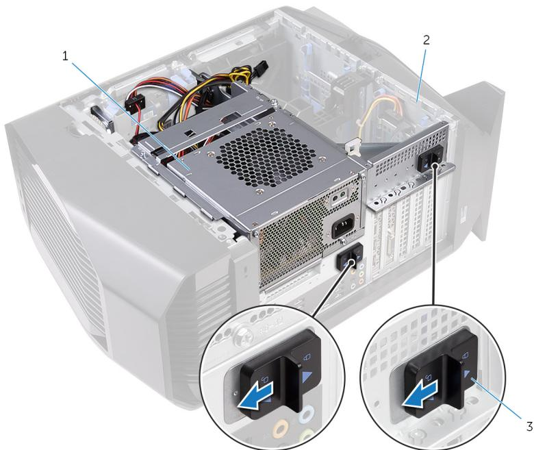
**图 18: 滑动电源装置固定框架释放门锁**
