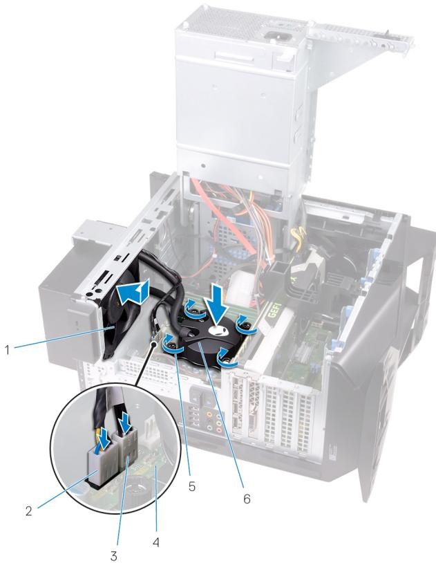
图 22: 装回处理器冷却部件
