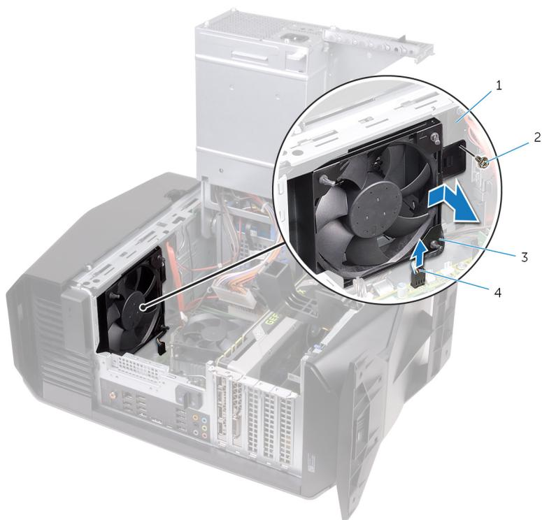
**图 39: 卸下机箱顶部风扇**
