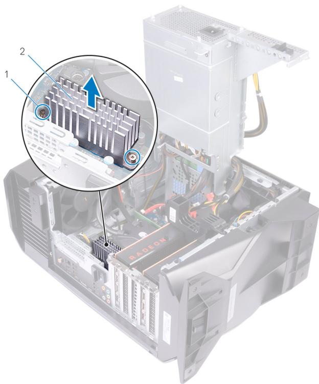
图 20: 卸下 VR 散热器
