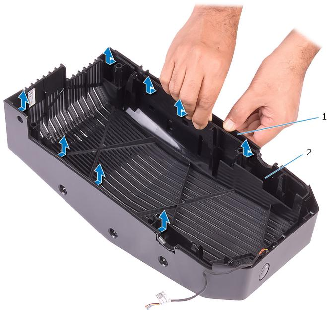
图 10: 从顶部挡板释放将顶盖
