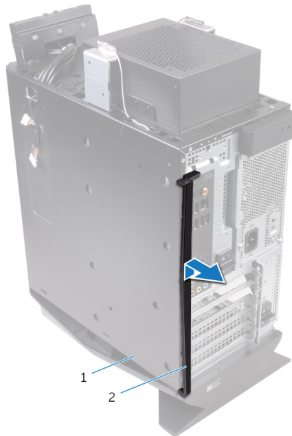
Figur 49. Ta bort det bakre trimhöljet
