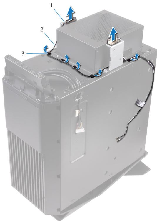
**Figura 36. Como remover os cabos da antena**
