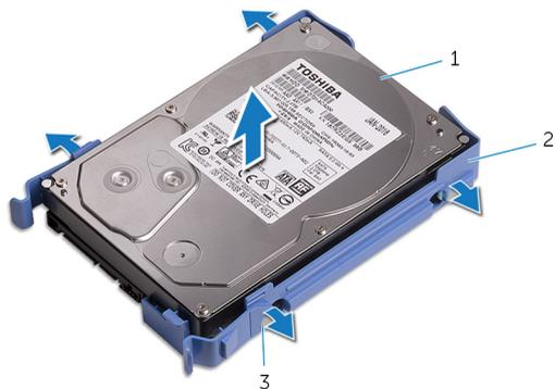
**Figura 14. Como remover o disco rígido do respectivo suporte**
