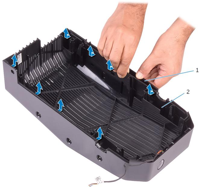
**Figura 10. Como soltar a tampa superior do bezel superior**
