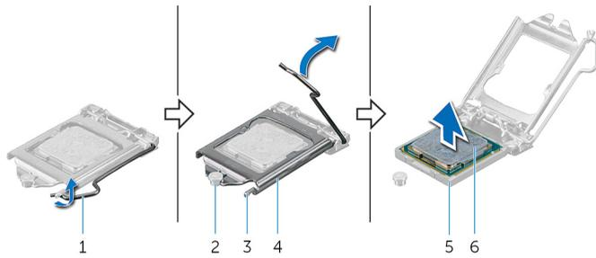
**Figura 31. Como remover o processador**
