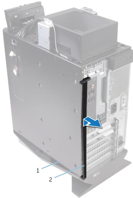
**Figura 49. Rimuovere il pannello posteriore**
