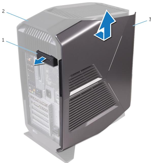
**Figura 2. Rimozione del pannello laterale sinistro**
