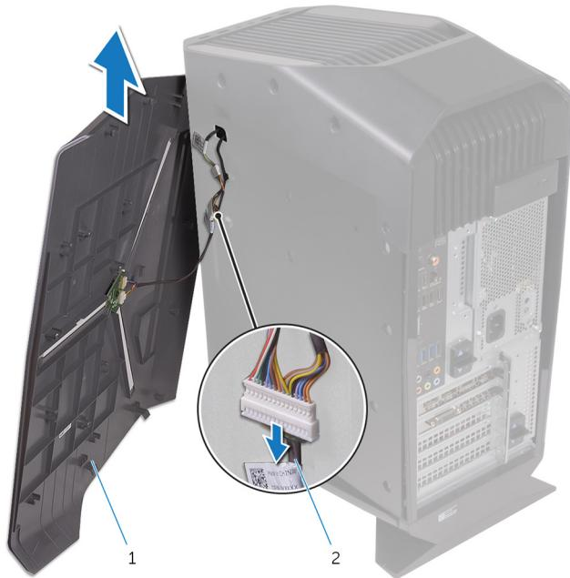
**Figura 5. Rimozione del pannello laterale destro**
