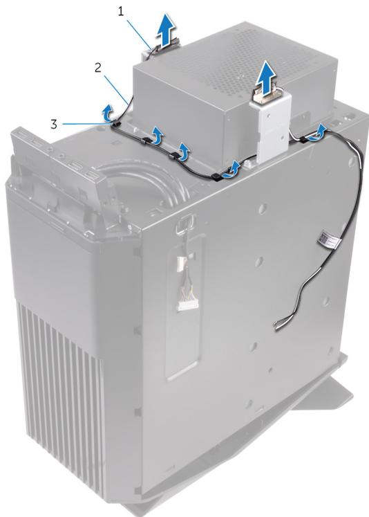
**Figura 36. Rimuovere i cavi dell'antenna**
