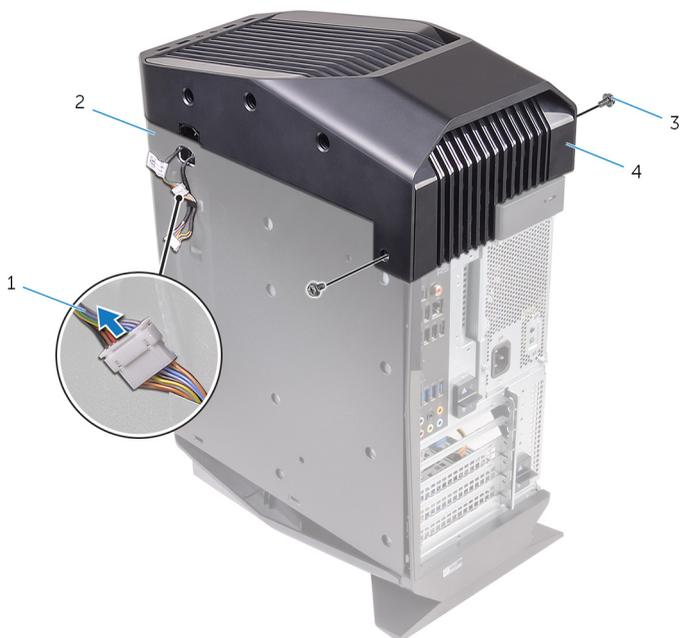
**Figura 8. Rimozione del coperchio superiore**
