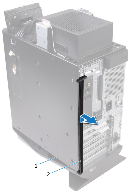
49. ábra. A hátsó szegélylemez levétele
