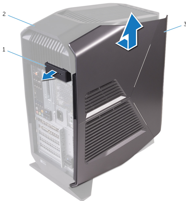
2. ábra. A bal oldali burkolat eltávolítása
