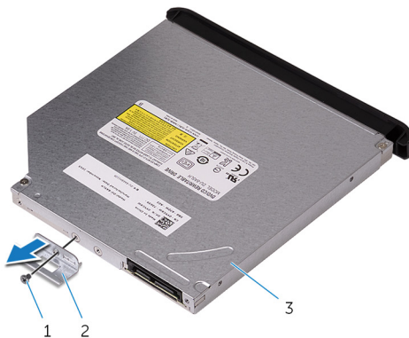
43. ábra. Az optikai meghajtó eltávolítása
