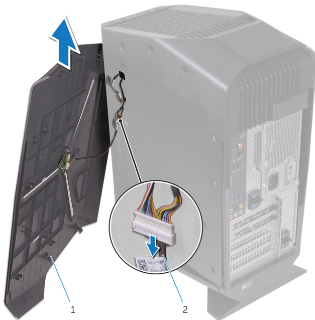
5. ábra. A jobb oldali burkolat eltávolítása
