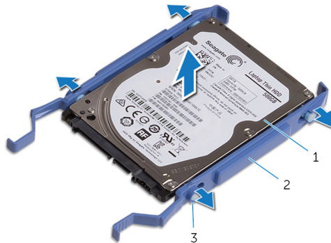
16. ábra. A merevlemez-meghajtó kivétele a tartóból
