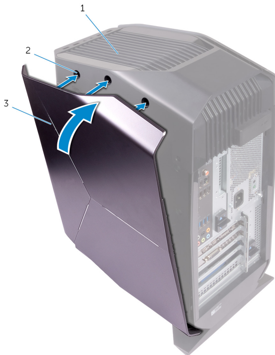
7. ábra. A jobb oldali burkolat visszahelyezése
