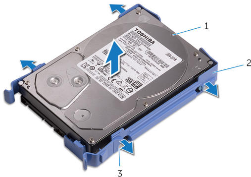
14. ábra. A merevlemez-meghajtó kivétele a tartókeretből
