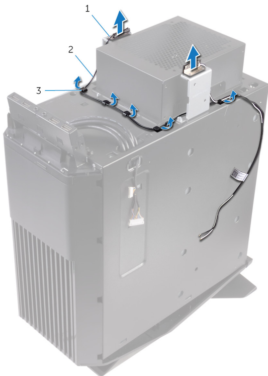
36. ábra. Az antennakábelek eltávolítása
