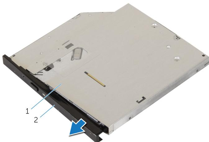
**Figura 44. Extracción de la unidad óptica**
