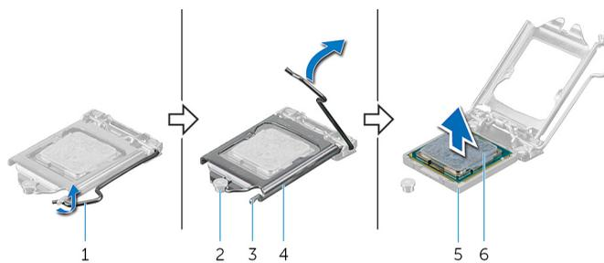
**Figura 31. Extracción del procesador**
