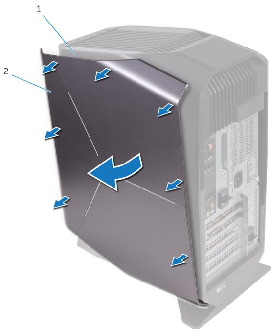
**Figura 4. Extracción de la cubierta lateral derecha**
