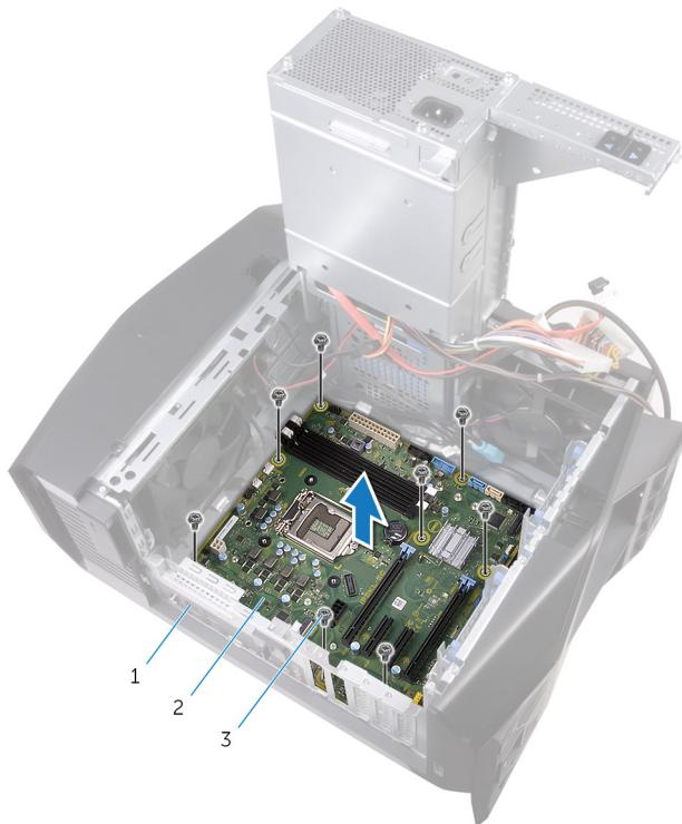
**Figura 51. Extracción de la placa base**
