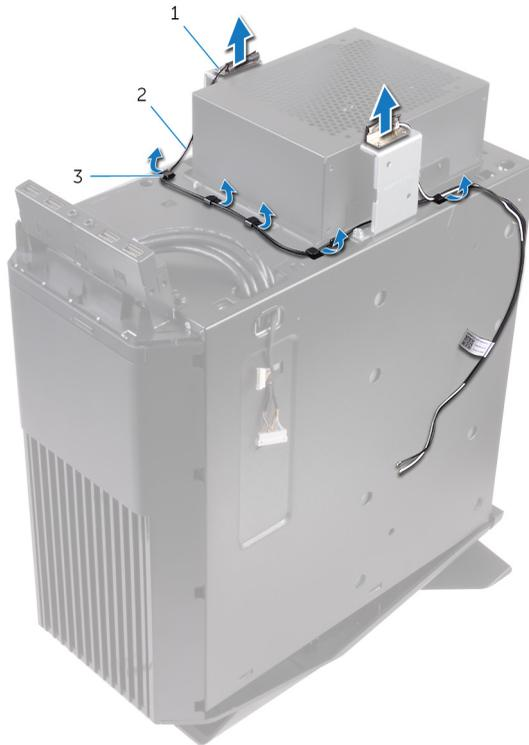
**Figura 36. Extracción de los cables de la antena**
