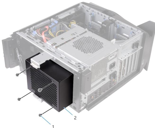
**Figura 19. Extracción del conjunto de refrigeración del procesador**
