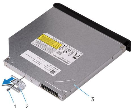
**Figura 43. Extracción de la unidad óptica**
