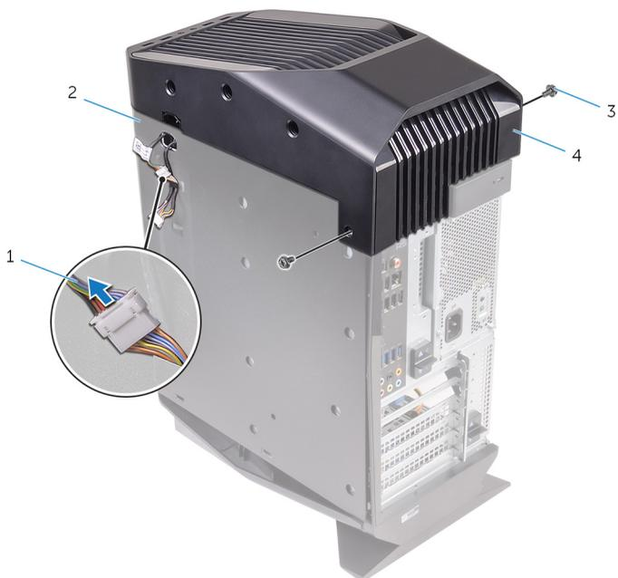
**Figura 8. Extracción de la cubierta superior**
