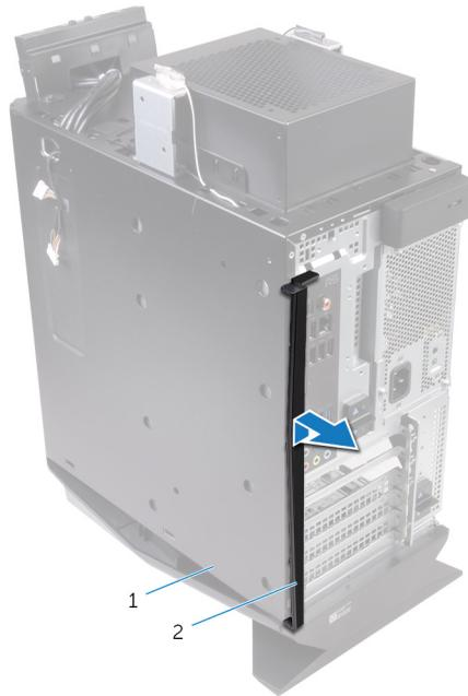
**Figura 49. Extracción de la cubierta de la parte trasera**
