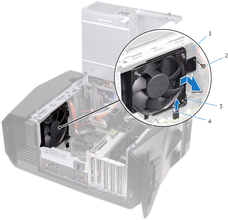
شكل 39. إزالة مروحة الهيكل العلوي
