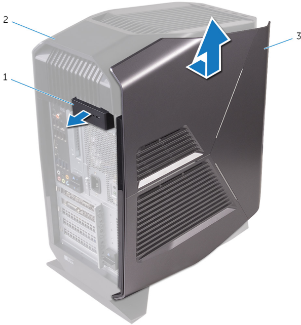
شكل 2. إزالة غطاء الجانب الأيسر
