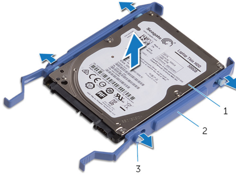
شكل 16. إزالة محرك الأقراص الثابتة من الحامل الخاص به
