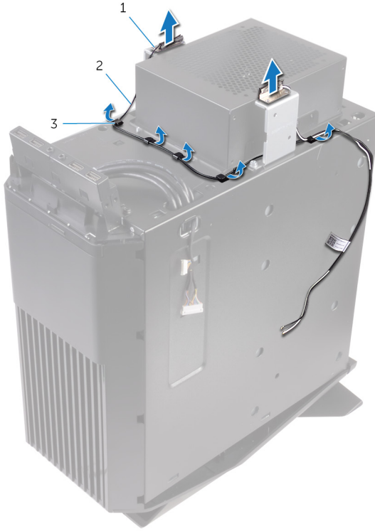
شكل 36. إزالة كابلات الهوائي
