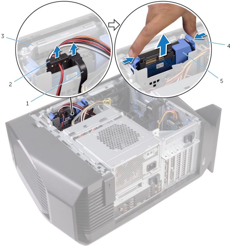
شكل 13. إزالة محرك الأقراص الثابتة
