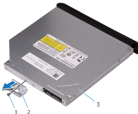
شكل 43. إزالة محرك الأقراص الضوئية
