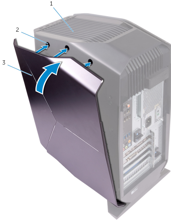
Kuva 7. Oikeanpuoleisen kannen asentaminen
