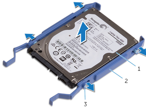
Kuva 16. Kiintolevy irrottaminen kiintolevykelkasta
