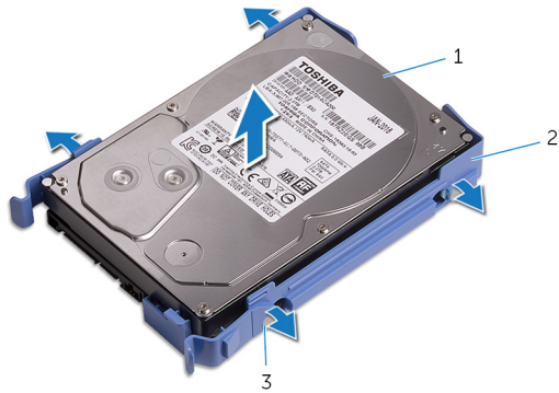
Kuva 14. Kiintolevyn irrottaminen kiintolevyn kiinnikkeestä
