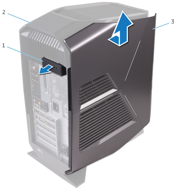
Kuva 2. Vasemmanpuoleisen kannen irrottaminen
