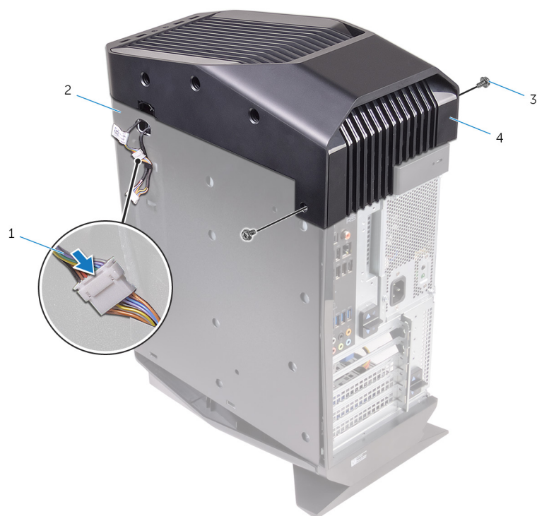
Рисунок 15. Установка верхней крышки
