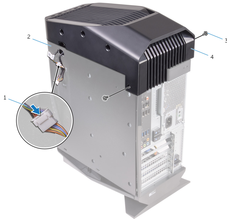
Afbeelding 15. De bovenkap terugplaatsen
