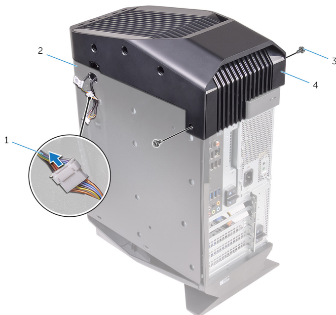
Figura 9. Rimozione del coperchio superiore
