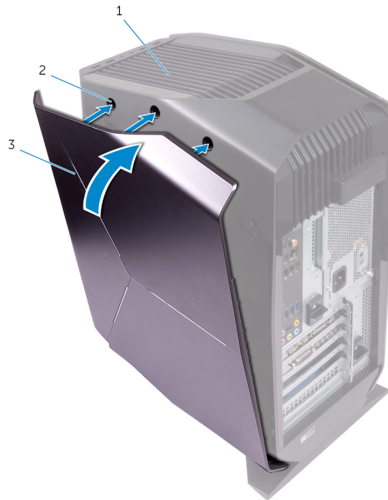
Figure 17. Remise en place du panneau latéral droit
