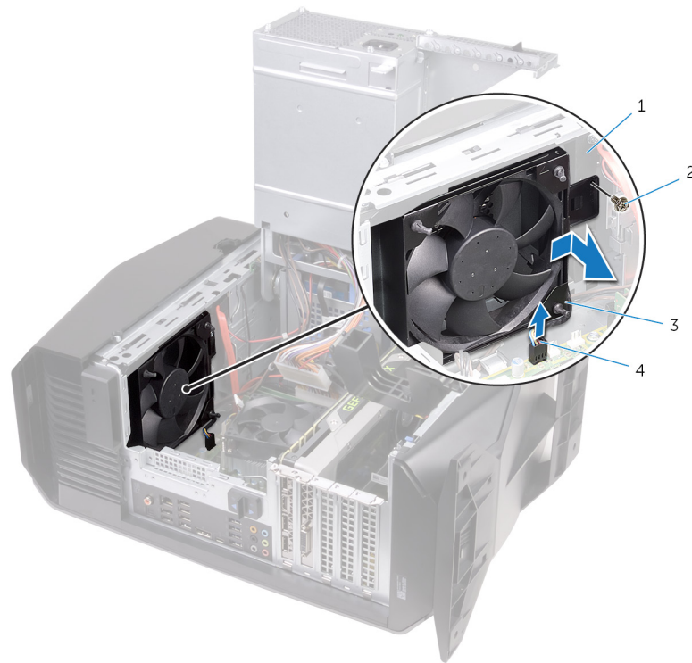
Figure 6. Retrait du ventilateur haut du châssis
