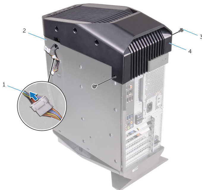
Figure 9. Retrait du capot supérieur de l'ordinateur.
