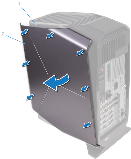
Ilustración 7. Extracción de la cubierta lateral derecha
