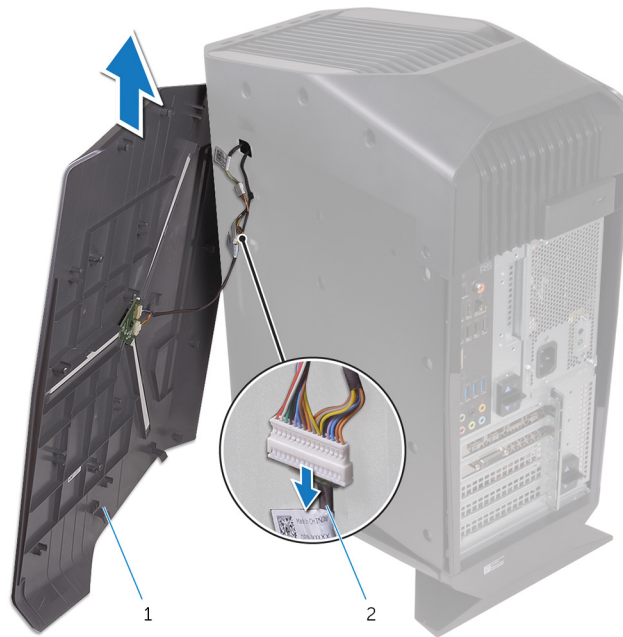
Abbildung 8. Entfernen der rechten Abdeckung
