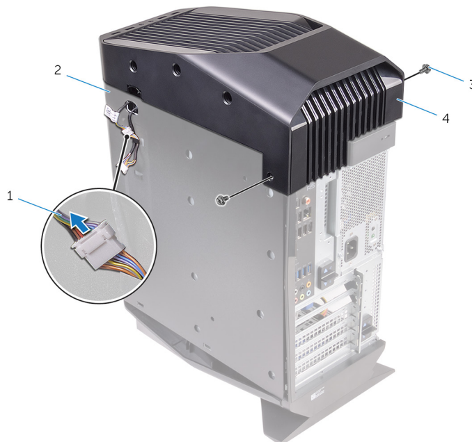
Abbildung 9. Entfernen der oberen Abdeckung
