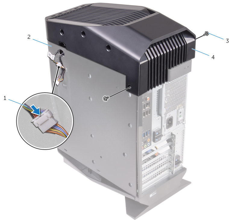
Abbildung 15. Auswechseln der oberen Abdeckung
