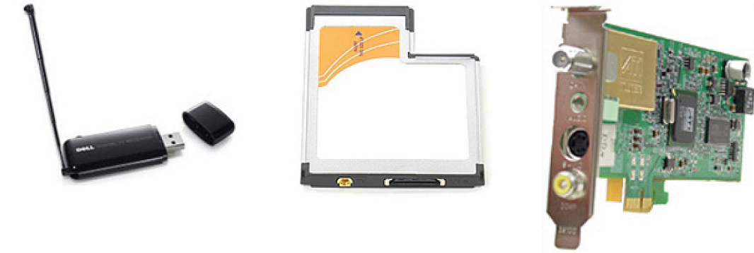
ភាគច្រើនកម្មវិធីទូរទស្សន៍នៅដាច់តែឯង ប៉ុន្តែកាតវិទ្យុខ្លះក៏មានកម្មវិធីទូរទស្សន៍នៅក្នុងស្រាប់។ សម្រាប់ព័ត៌មានបន្ថែមក្នុងការប្រើប្រាស់កម្មវិធីទូរទស្សន៍សូមមើលឯកសាររបស់កម្មវិធីទូរទស្សន៍។
