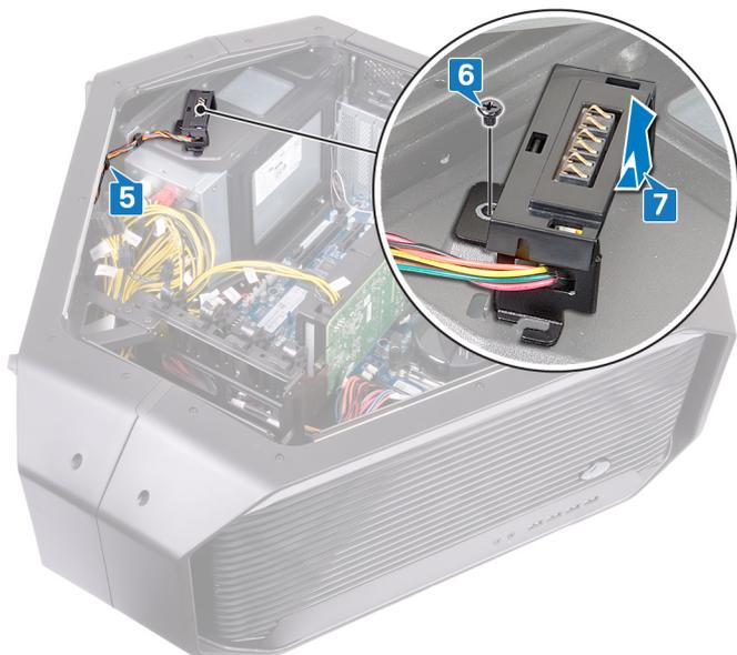
8 卸下將 AlienFX 側面板連接器固定至托架的兩顆螺絲 (#6-32x6)。
