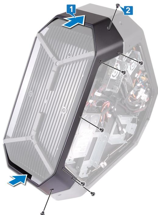
3 裝回將底部把手固定在機箱右側的七顆螺絲 (#6-32x6.5)。
