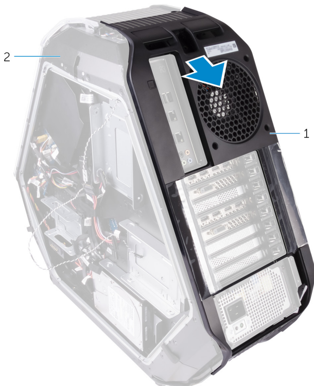
Figur 69. Ta bort den bakre ramen
