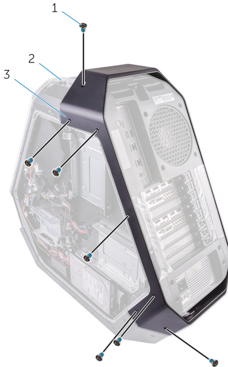
Figura 52. Rimozione delle viti
