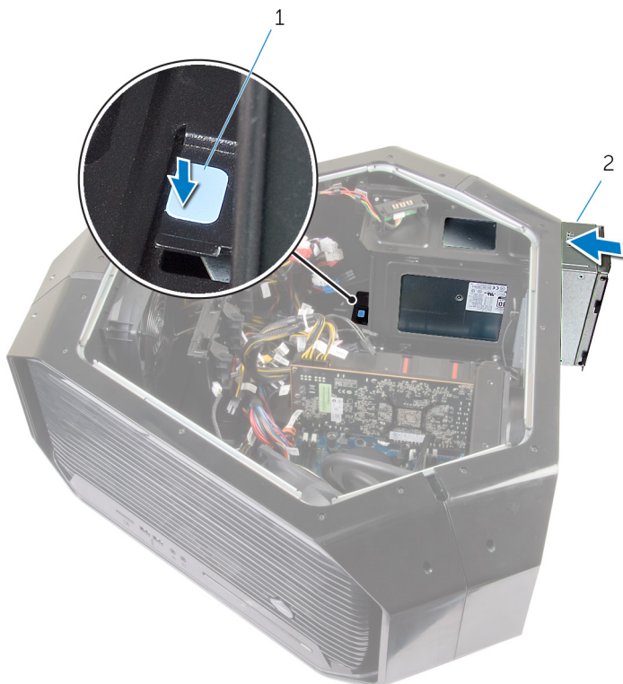
Figura 50. Ricollocamento dell'unità di alimentazione
