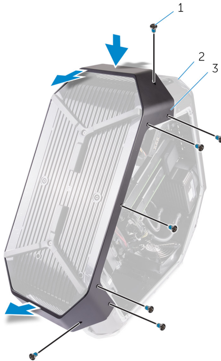
Figura 57. Rimozione della maniglia inferiore
