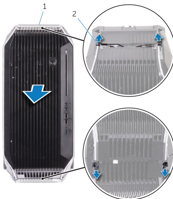
Figura 60. Rimozione del frontalino anteriore
