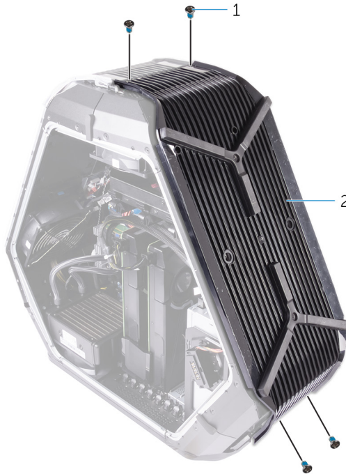
Figura 70. Rimozione del pannello della base
