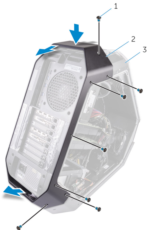
Figura 53. Rimozione della maniglia posteriore
