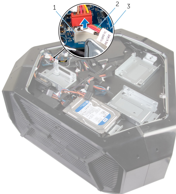
Figura 17. Immagine: Rimozione del connettore sinistro AlienFX
