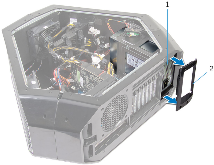
Figura 48. Rimozione dell'unità di alimentazione
