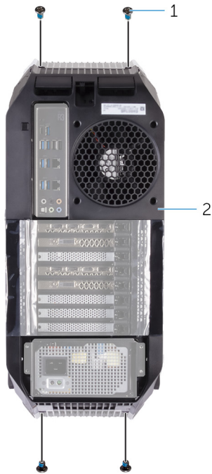
Figura 67. Rimozione del pannello posteriore
