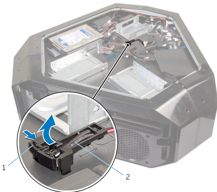
Figura 23. Rimozione del cavo del sensore termico dell'alloggiamento dell'unità
