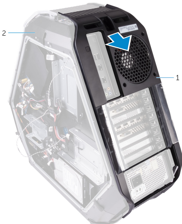
Figura 69. Rimozione del pannello posteriore
