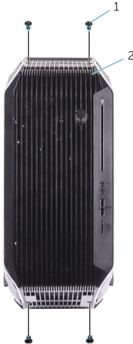
Figura 58. Extracción de los tornillos
