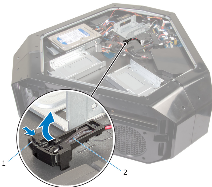
Figura 23. Extracción del cable del sensor de calor del compartimento de la unidad
