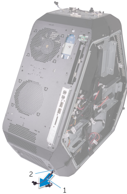
Figura 77. Extracción de los cables de luz tron inferiores
