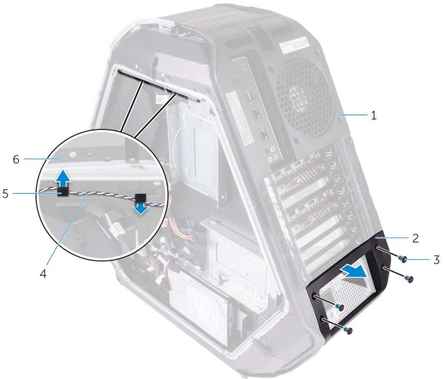
Figura 66. Eliminación del cable para iluminación de accesibilidad de E/S posterior
