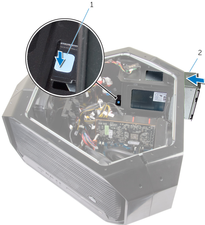
Figura 50. Colocación de la unidad de fuente de alimentación
