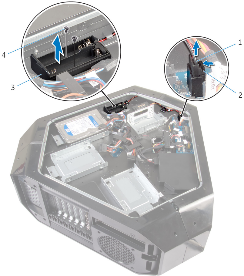
Figura 10. Extracción de la carcasa de baterías
