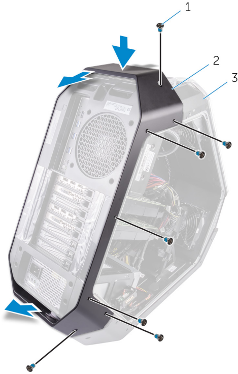
شكل 53. إزالة ذراع التوجيه الخلفي
