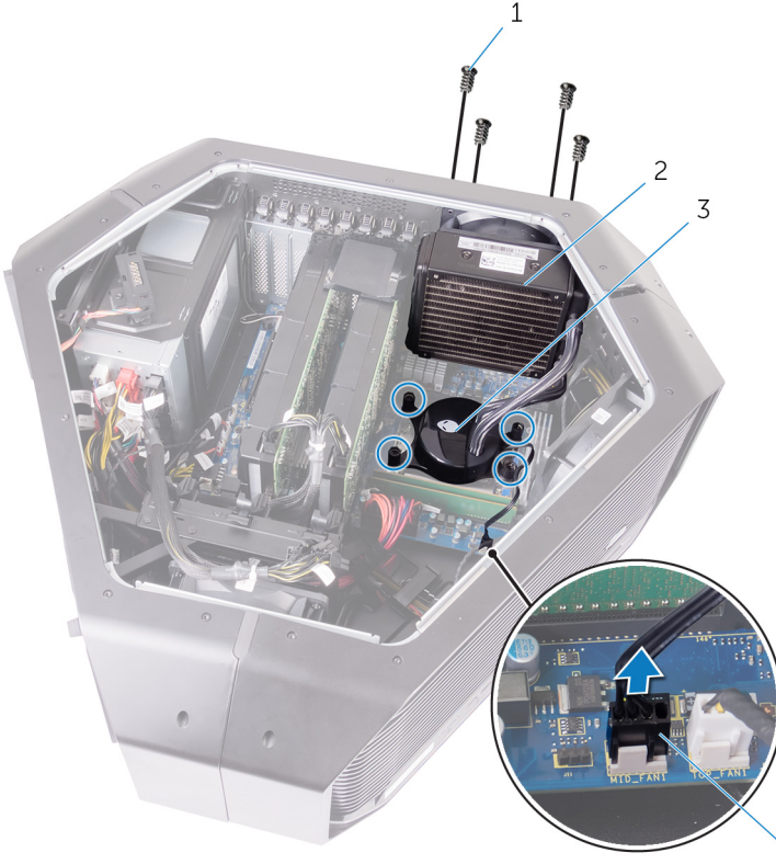
شكل 45. إزالة مجموعة تبريد المعالج بالسوائل
