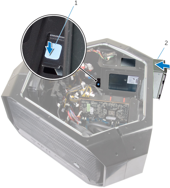
شكل 50. إعادة وضع وحدة الإمداد بالتيار
