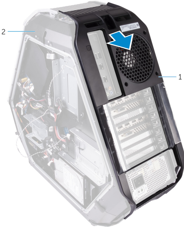
شكل 69. إزالة إطار التثبيت الخلفي
