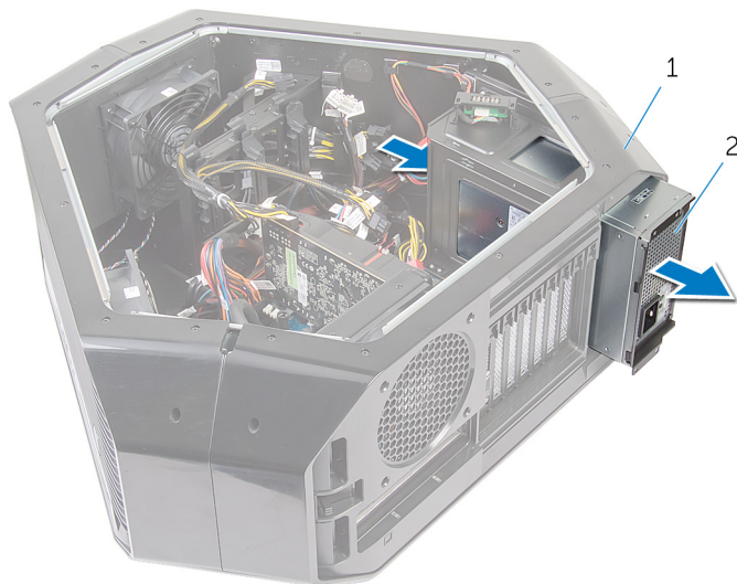
図 51. 電源装置ユニットの取り外し
