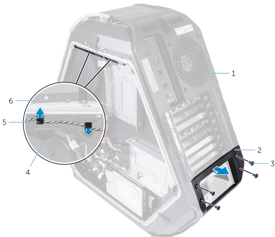
図 68. 背面 I/O アクセシビリティ照明ケーブルの取り外し
