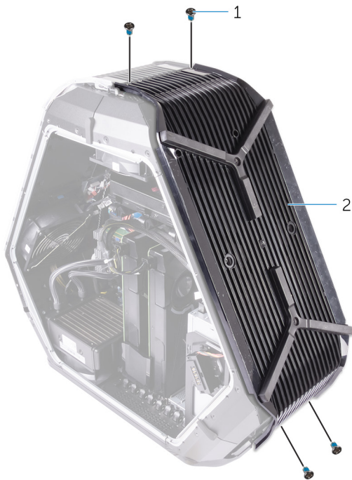
図 72. ベースパネルの取り外し
