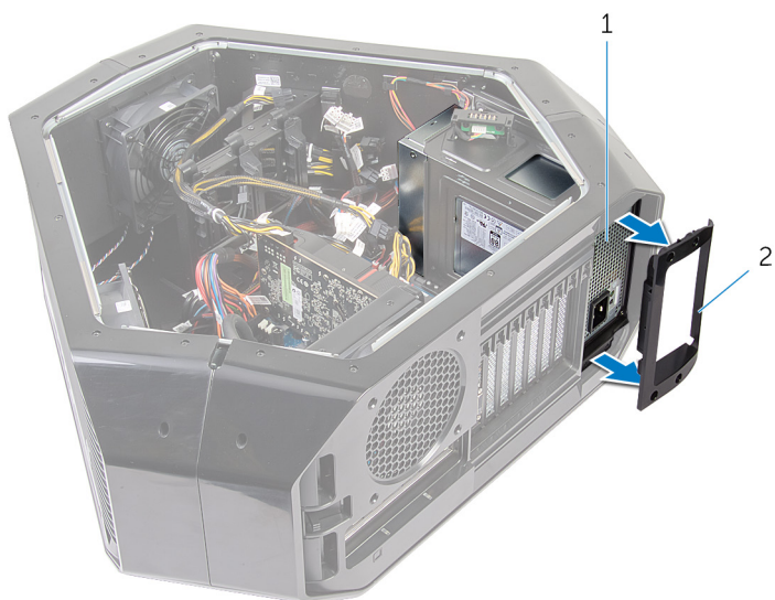
図 50. 電源装置ユニットの取り外し
