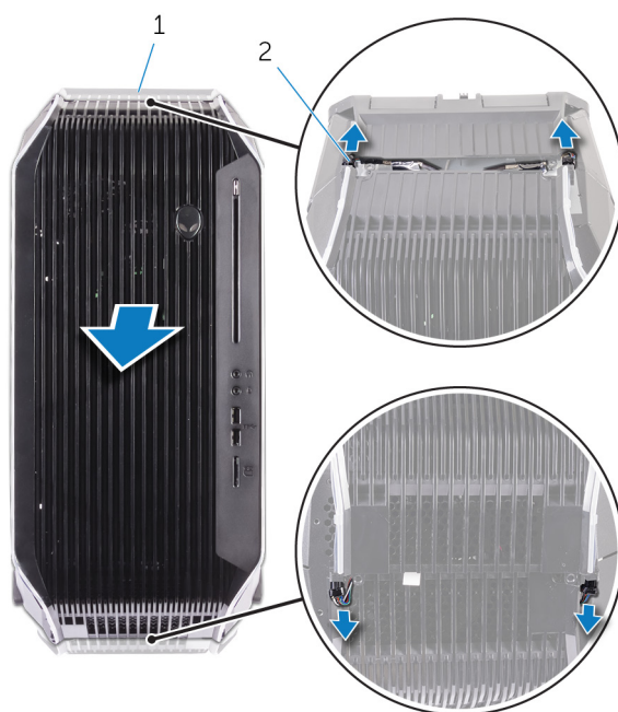
図 62. 前面ベゼルの取り外し
