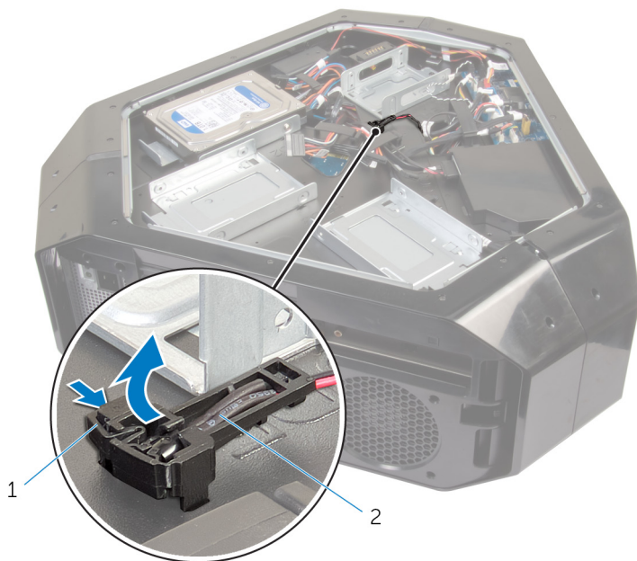
図 23. ドライブベイ熱センサーケーブルの取り外し
