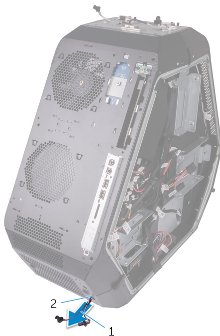
図 79. 下部トロンライトケーブルの取り外し
