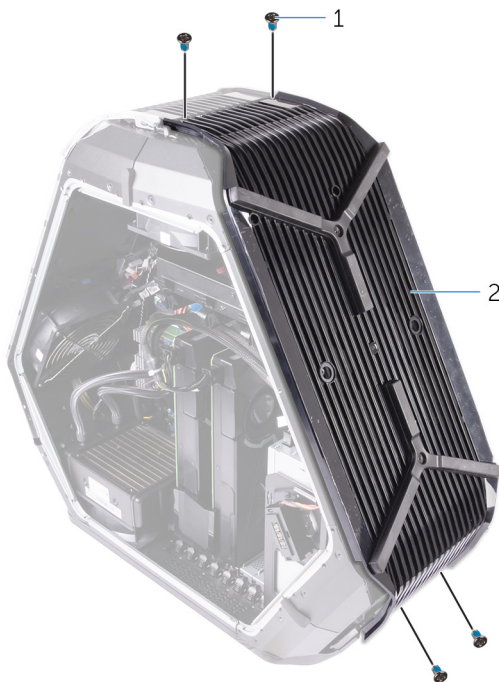
Abbildung 72. Entfernen der Bodenplatte
