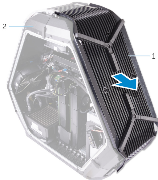
Abbildung 75. Entfernen der Bodenplatte
