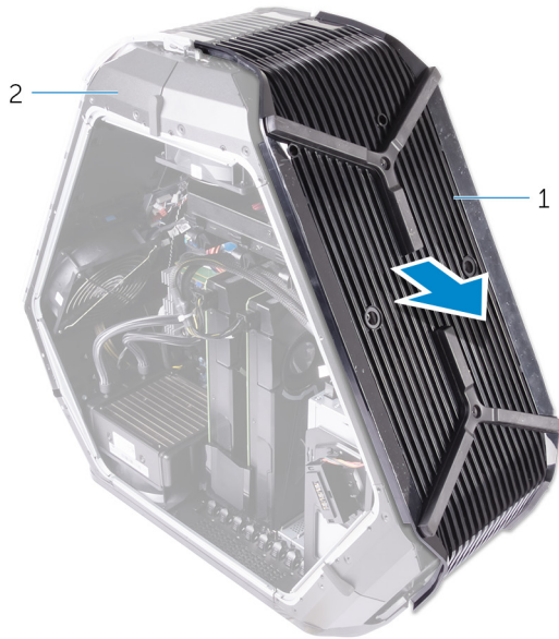
Figur 75. Sådan fjernes bundpanelet
