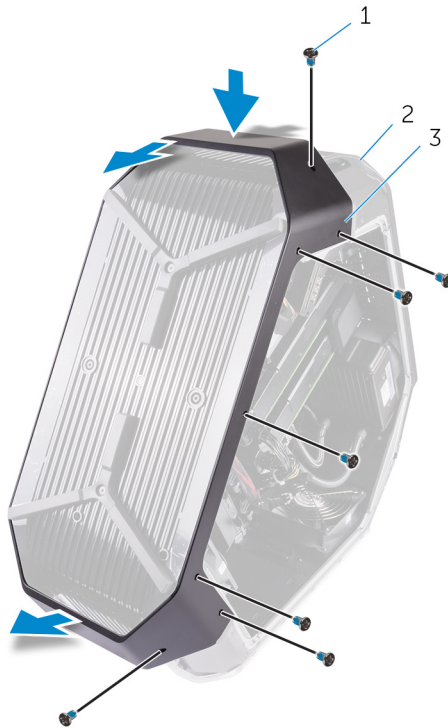
Figur 59. Fjernelse af det nederste håndtag
