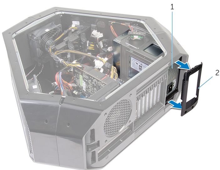
Figur 50. Sådan fjernes strømforsyningsenheden
