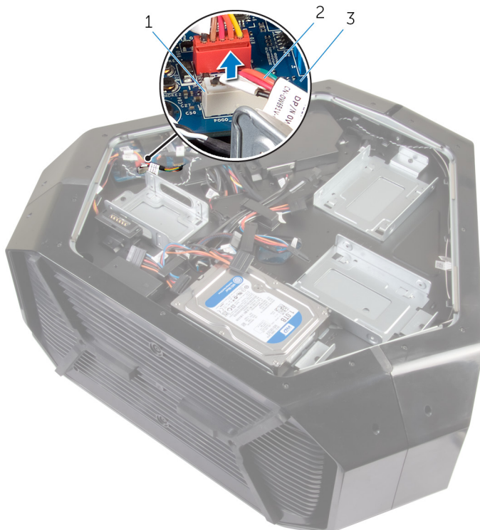
Figur 17. Billede: Fjernelse af venstre AlienFX-stikmodul
