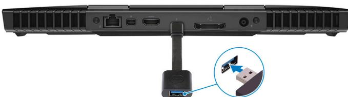
8. 将 Oculus Rift 的触控追踪仪连接至解密器的 USB A 型端口
