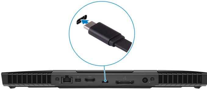
5. 将 Oculus Rift 追踪仪连接至计算机左侧的 USB A 型端口。
