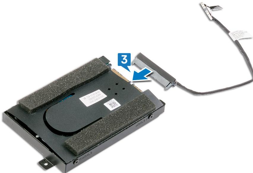
**4** Alinhe os orifícios dos parafusos no conjunto do disco rígido com os orifícios dos parafusos no conjunto do apoio para as mãos.
