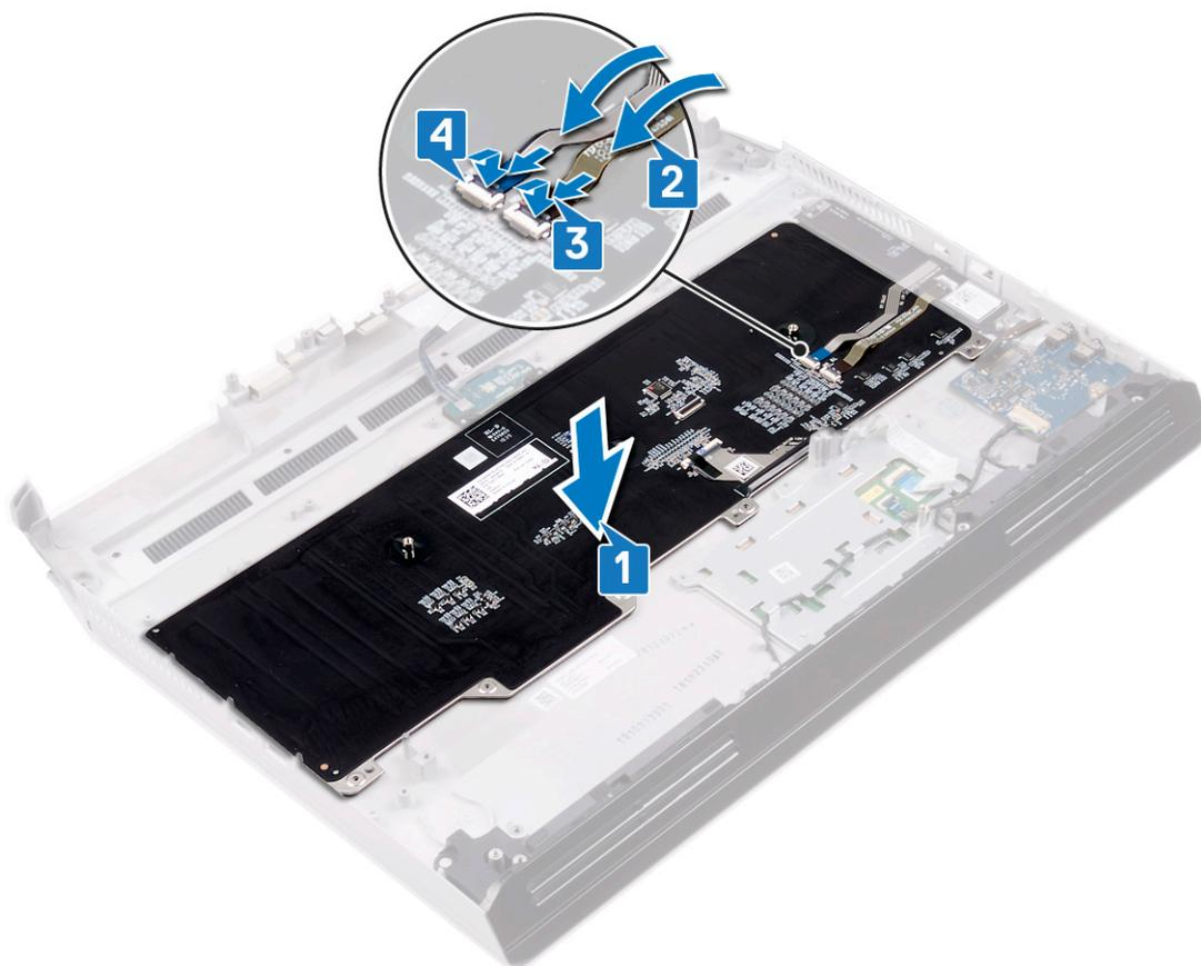
5. Faites glisser le support du clavier dans les logements situés sur l'ensemble repose-mains.
