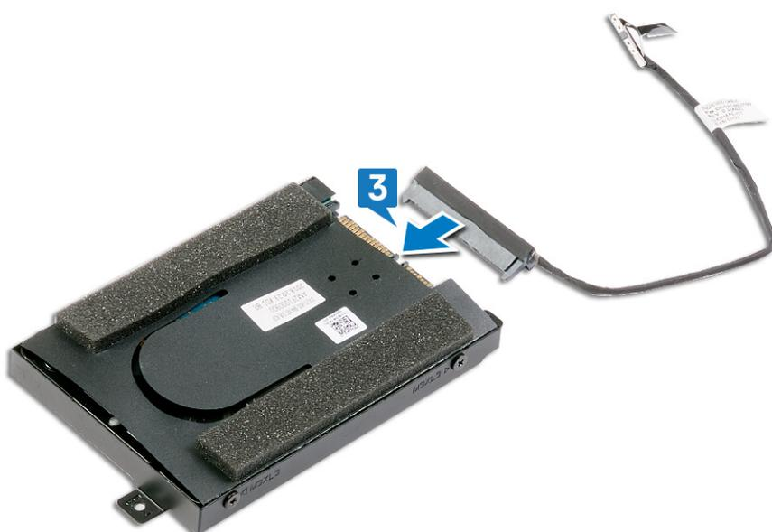
4. Alignez les trous de vis de l'assemblage de disque dur avec ceux de l'assemblage de repose-mains.
