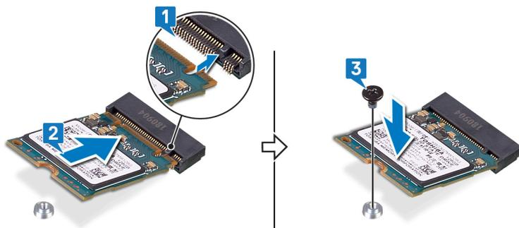
4. Alignez les trous de vis de l'écran thermique M.2 avec les trous de vis de l'ensemble repose-mains et de la carte système.
