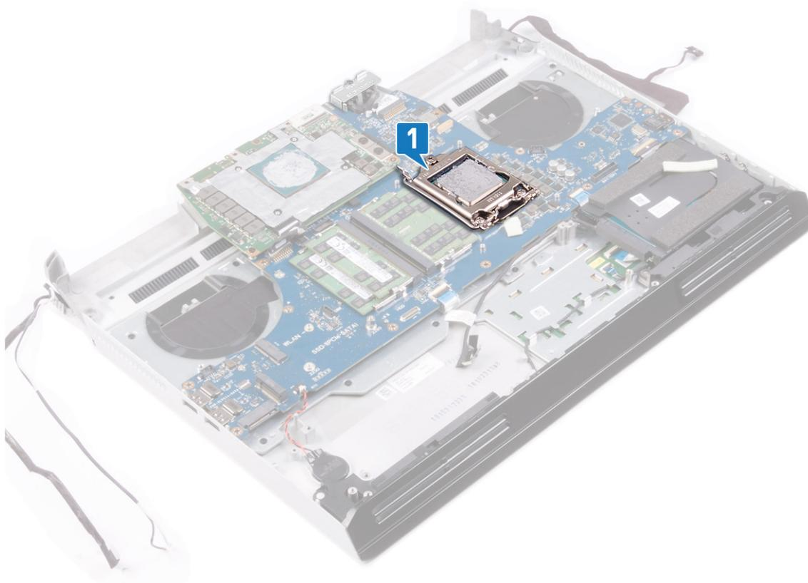
2. Appuyez sur le levier sur le cache du processeur et déplacez-le pour l'extraire du processeur.
