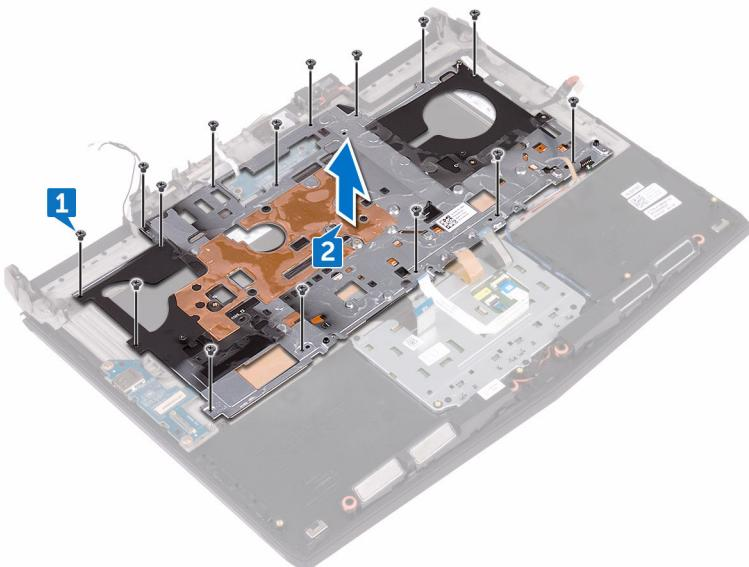
**3** 傾斜的將鍵盤提起，然後將之從手掌墊組件上的彈片卸下。。
