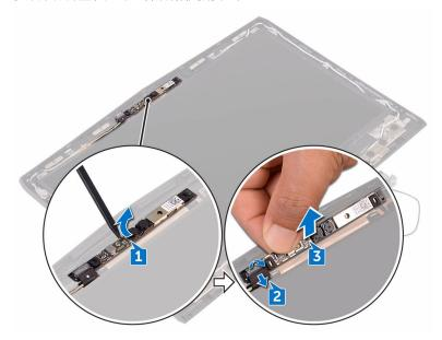
4 按照<u>卸下顯示器背蓋和天線組件</u>中步驟 2 的程序卸下攝影機纜線。
