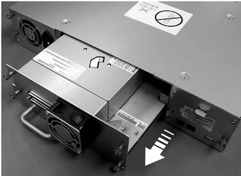
图 142. 将磁带机箱从磁带库中拉出（图示为不带 ESD 簧片的磁带机箱）
