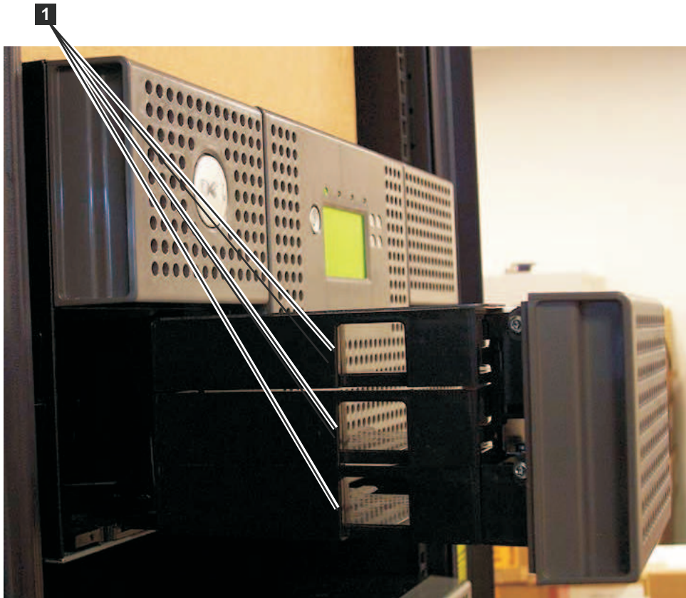
图 63. 4U 磁带库 I/O 站背面的指孔
