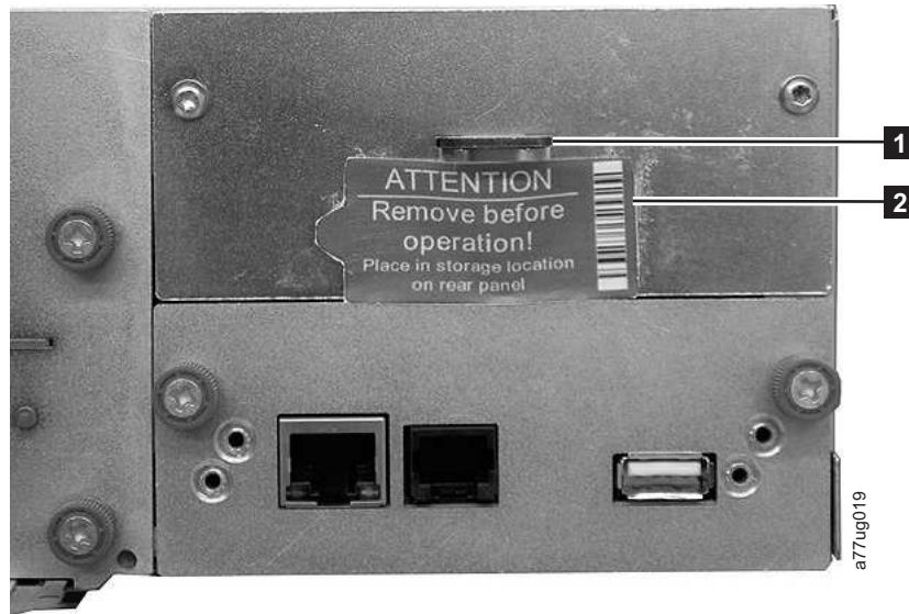
图 23. 磁带库装运锁和标签在磁带库后面板上的存放位置
