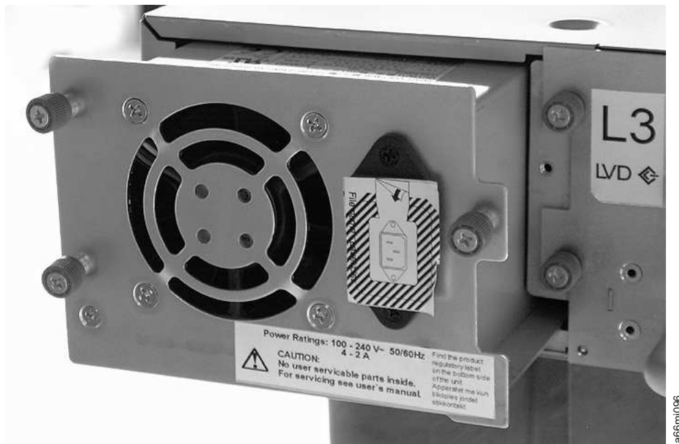
图 145. 正从 2U 磁带库卸下的电源
