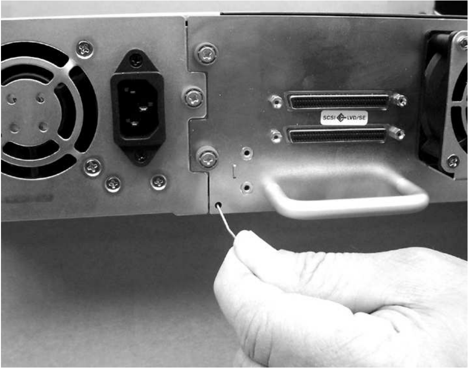
图 156. 左盒带箱的插孔（面向磁带库背面）
