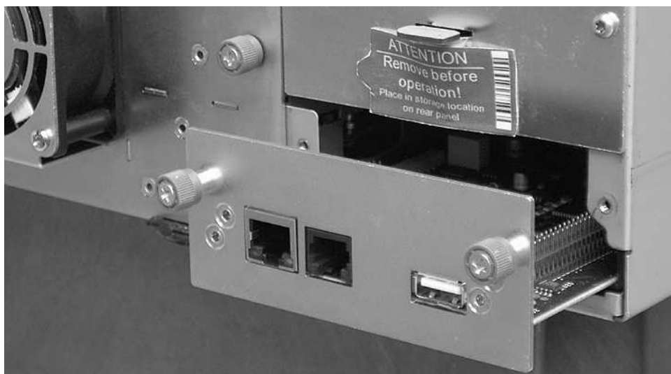
图 146. 正从磁带库卸下的磁带库控制器卡
