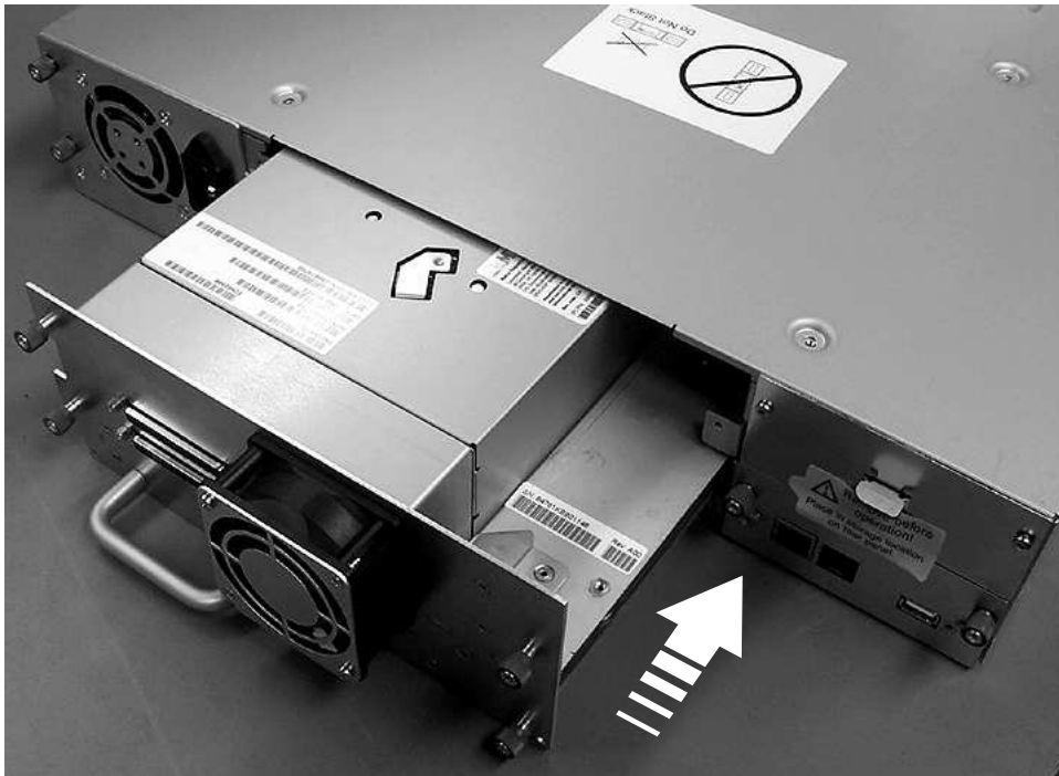
图 143. 将磁带机箱推入磁带库（显示的不带 ESD 簧片的磁带机箱）
