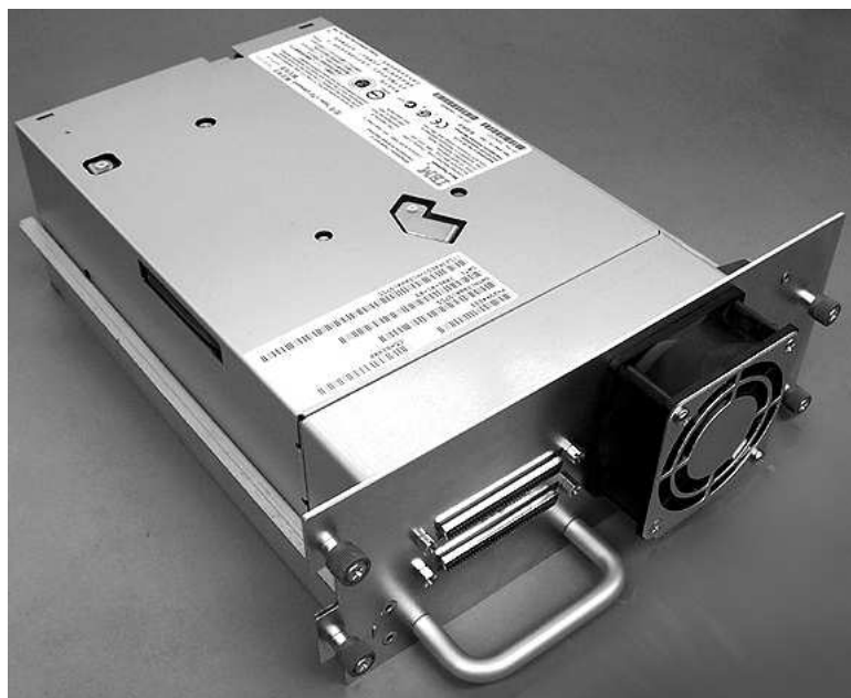
图 6. 不带 ESD 簧片的磁带库磁带机箱（图示为 SCSI 磁带机箱）
