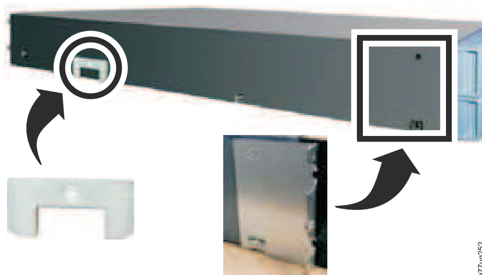
图 159. 用于将磁带库固定到机架中的安装支架和固定器（磁带库的每一侧使用一个支架和固定器）
