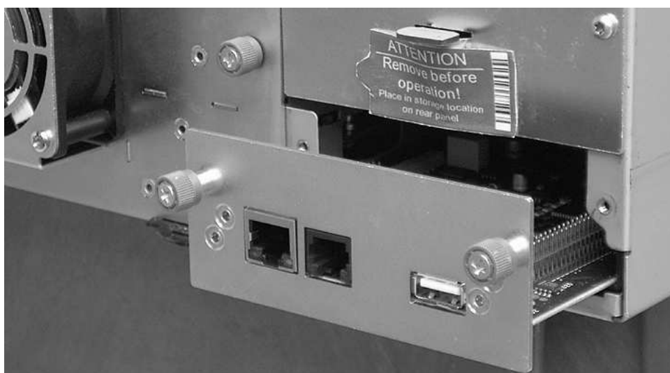
图 154. 从磁带库卸下磁带库控制器卡
