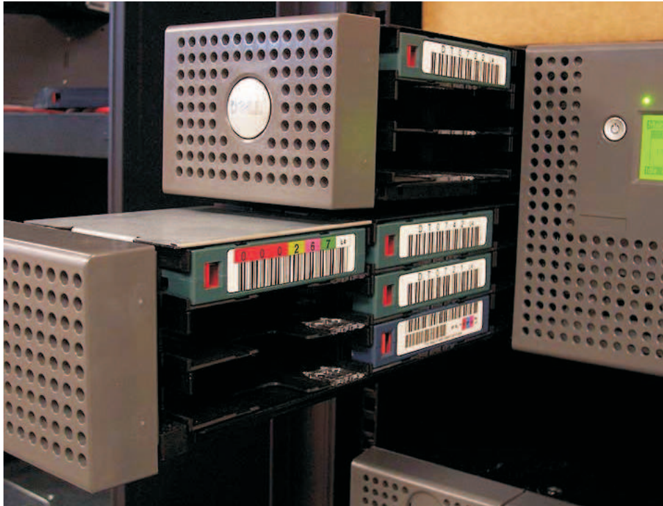
图 158. 从 4U 磁带库拉出的左盒带箱（面向磁带库正面）
