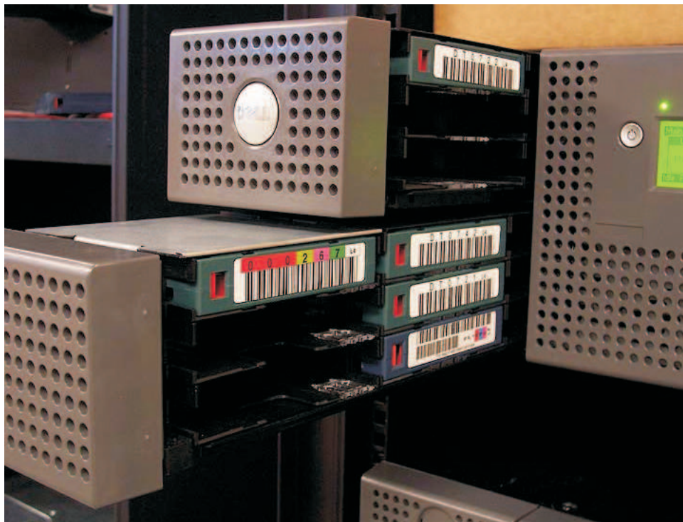
图 62. 左下盒带箱中的 4U 磁带库 I/O 站
