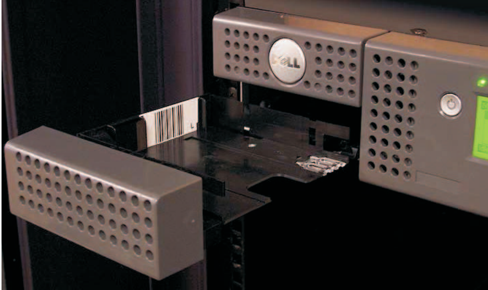
图 59. 左盒带箱中的 2U 磁带库 I/O 站
