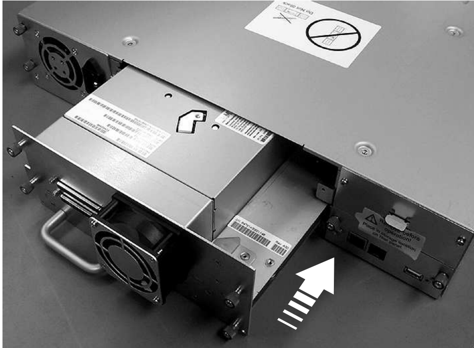
그림 143. 라이브러리에 드라이브 슬레드 밀어 넣기 (ESD 스프링이 없는 드라이브 슬레드 표시)
