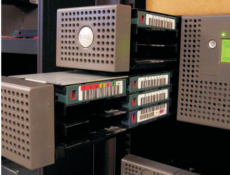
그림 62. 하단 왼쪽 매거진의 4U 라이브러리 입/출력(I/O) 스테이션
