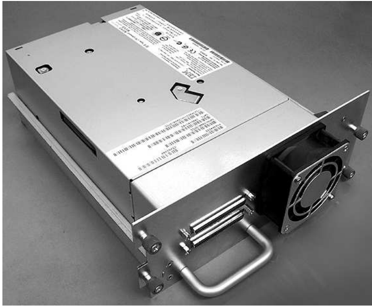
그림 6. ESD 스프링이 없는 라이브러리 드라이브 슬레드(SCSI 슬레드 표시)
