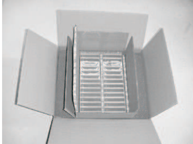
그림 128. 운송을 위해 테이프 카트리지를 이중으로 상자에 포장
