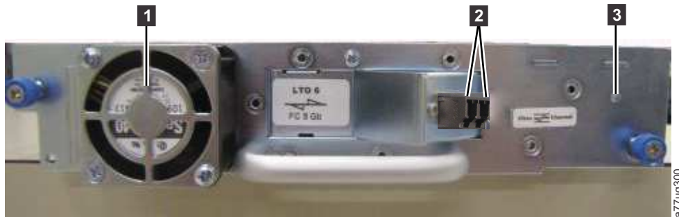
그림 3. half height 파이버 채널 드라이브의 뒷면 패널(드라이브 슬레드 전용)
