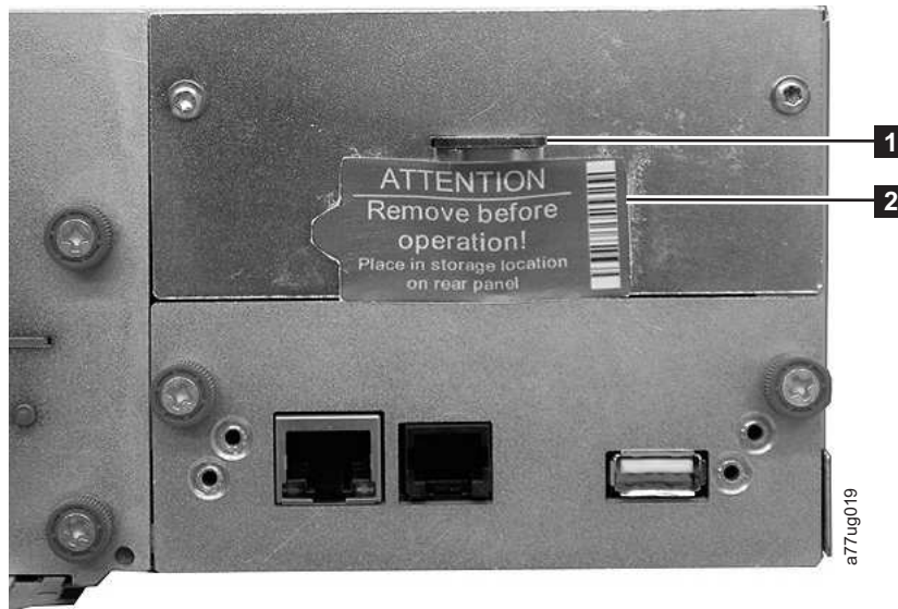
그림 23. 라이브러리 뒷면 패널의 라이브러리 선적용 잠금 장치 및 레이블 보관 위치
