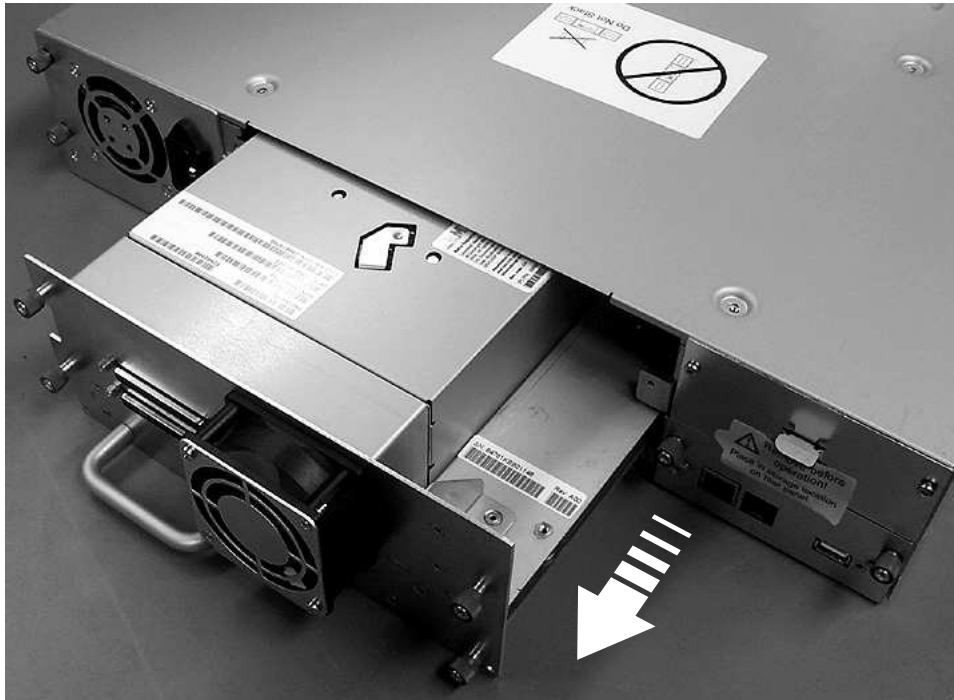
그림 151. 라이브러리에서 드라이브 슬레드 제거(ESD 스프링이 없는 드라이브 슬레드 표시)
