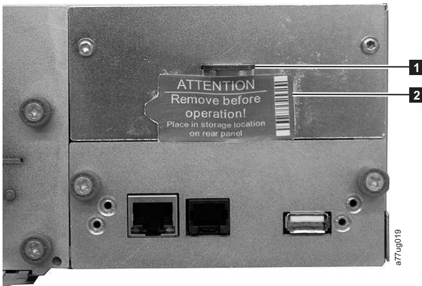
그림 150. 라이브러리 뒷면 패널의 라이브러리 선적용 잠금 장치 및 레이블 보관 위치
