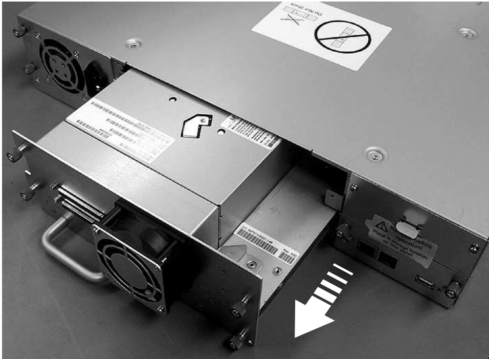
그림 142. 라이브러리에서 드라이브 슬레드 당겨 빼기(ESD 스프링이 없는 드라이브 슬레드 표시)
