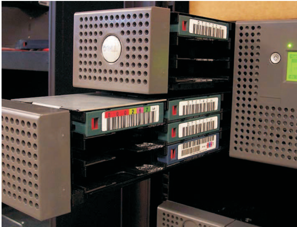
Figure 158. Magasins de gauche retirés de la bandothèque 4U (face avant de la bandothèque)
