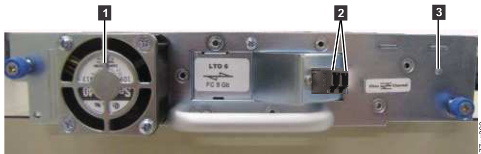
Figure 3. Panneau arrière (glissière d'unité uniquement) d'une unité Fibre Channel hauteur
