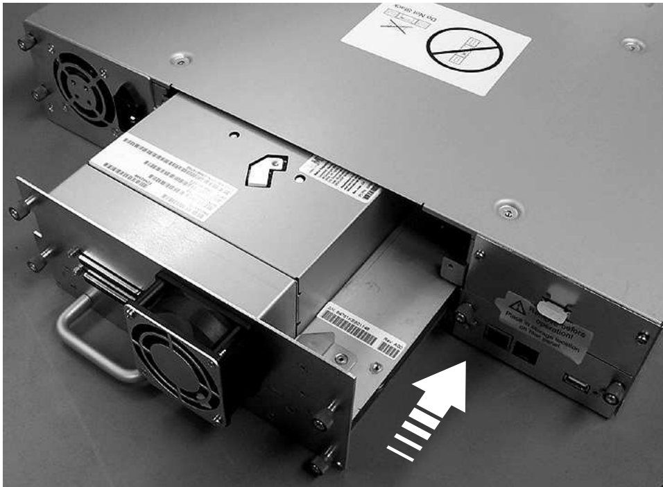
Figure 143. Insertion de la glissière d'unité dans la bandothèque (glissière d'unité sans ressorts ESD)
