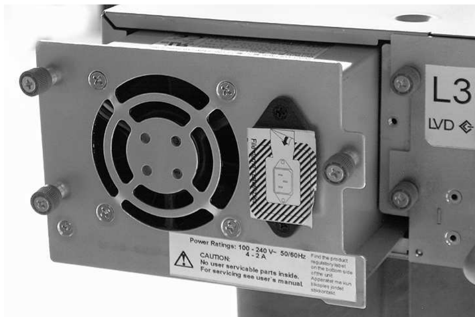
Figure 145. Retrait d'un bloc d'alimentation électrique d'une bande de logique 2U
