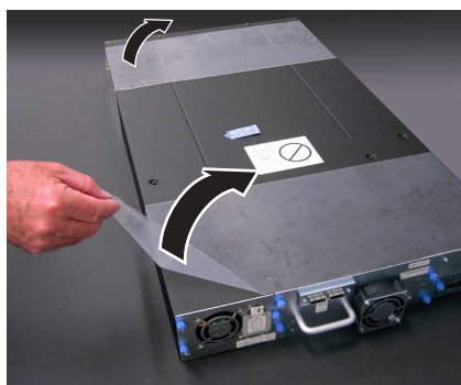
Figure 19. Retrait des couches de protection en plastique de la bandothèque
