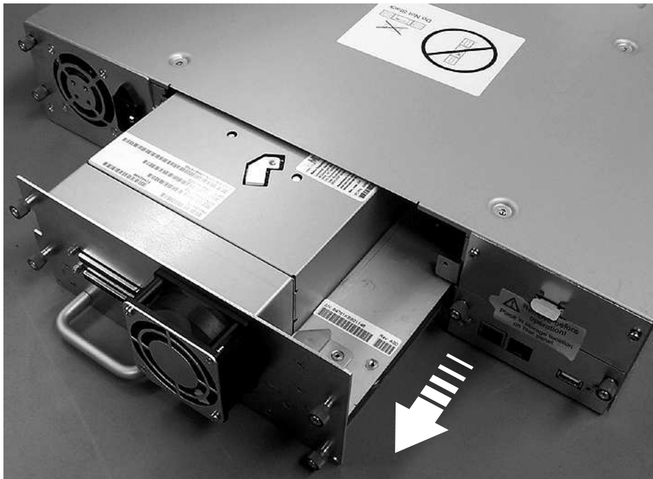
Figure 142. Retrait de la glissière d'unité de la bandothèque (glissière d'unité sans ressorts ESD)
