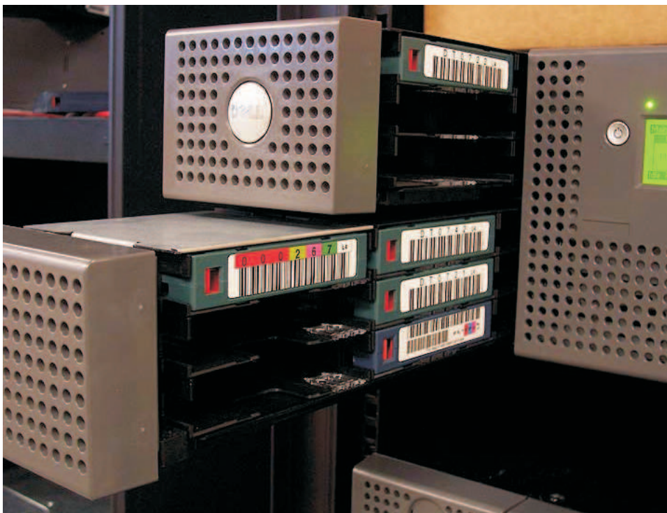
Figure 135. Magasins de gauche retirés de la bandothèque 4U
