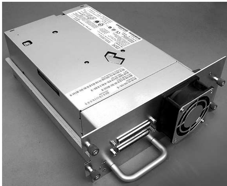
Figure 6. Glissière d'unité de la bandothèque sans ressorts ESD (glissière SCSI)
