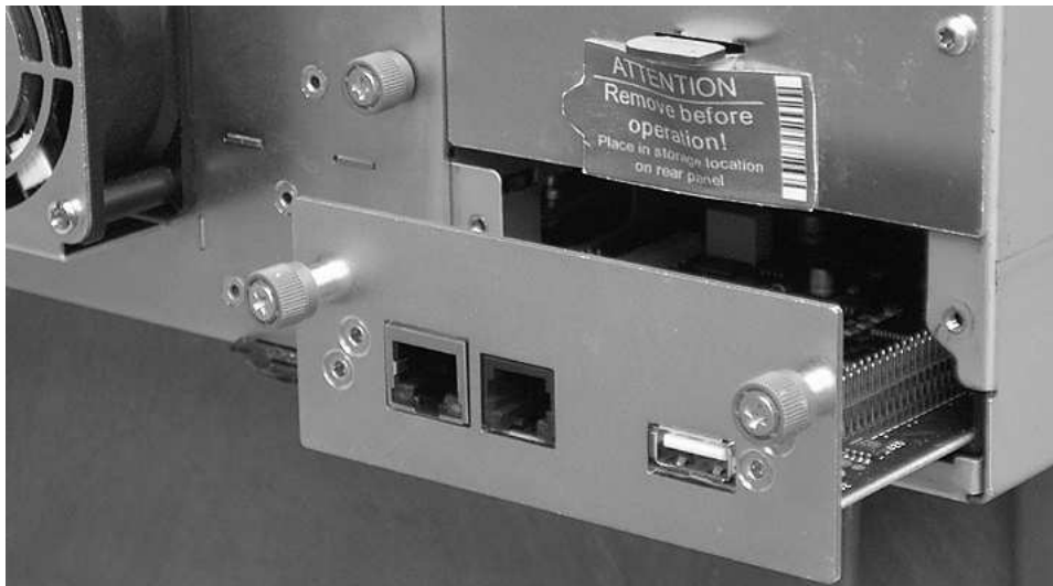
Figure 146. Retrait d'une carte contrôleur de la bandothèque
