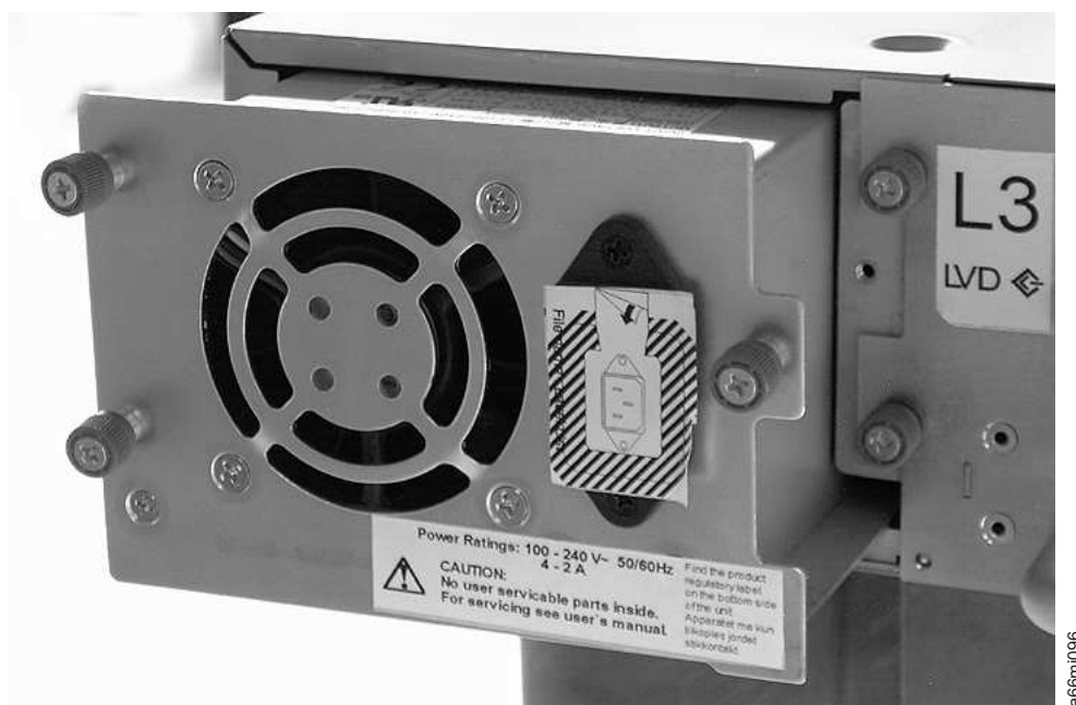
Figure 153. Bloc d'alimentation électrique retiré d'une bandothèque
