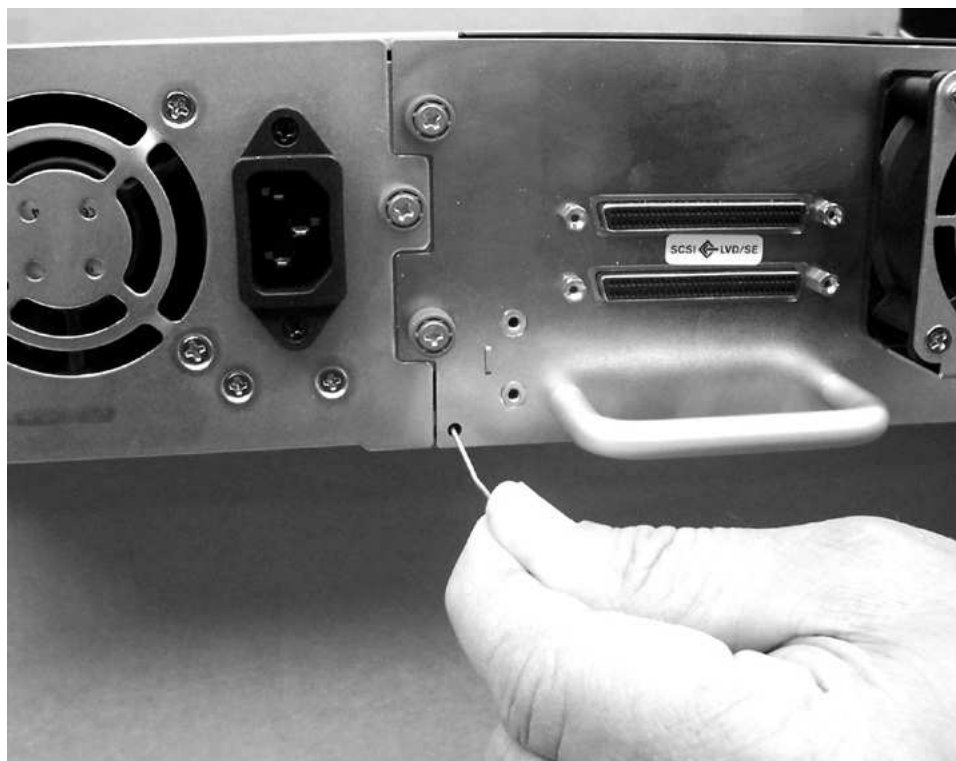
Figure 156. Orifice d'accès du magasin gauche (face arrière de la bandothèque)
