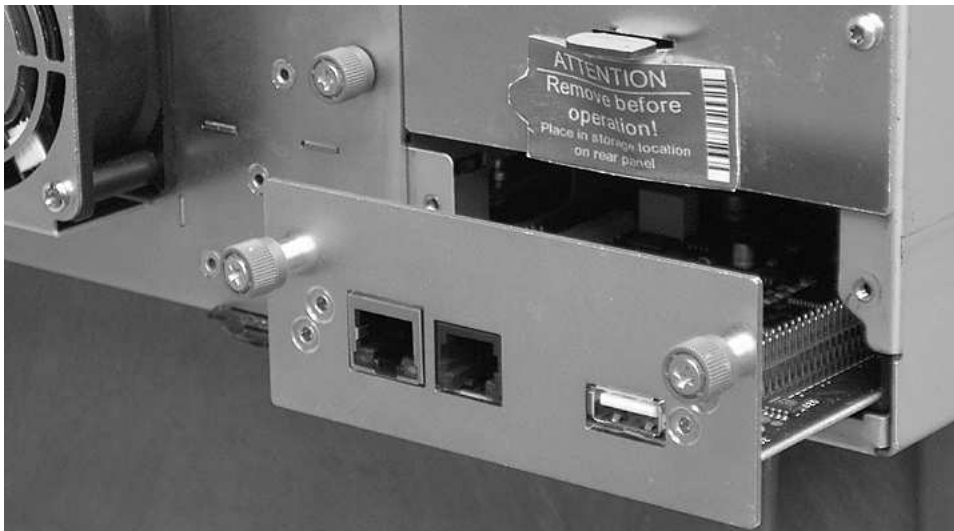
Figure 154. Retrait d'une carte contrôleur de la bandothèque
