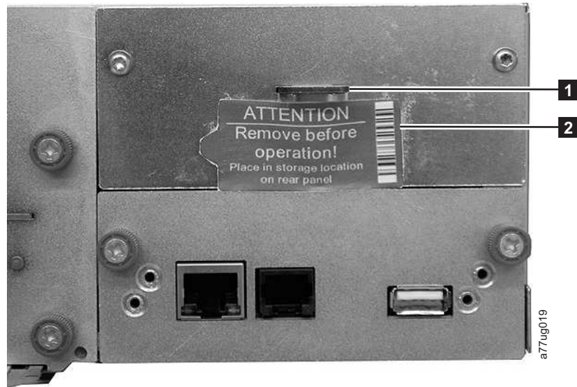
Figura 137. Ubicación de almacenamiento del bloqueo de transporte y la etiqueta
