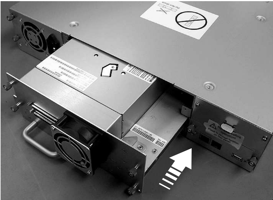
Figura 143. Colocación de la plataforma de unidad en la biblioteca (se muestra la plataforma de unidad sin muelles de ESD)
