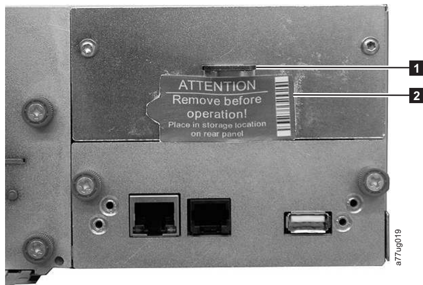
Figura 23. Ubicación de almacenamiento del bloqueo de transporte y la etiqueta de la biblioteca en el panel posterior de la biblioteca
