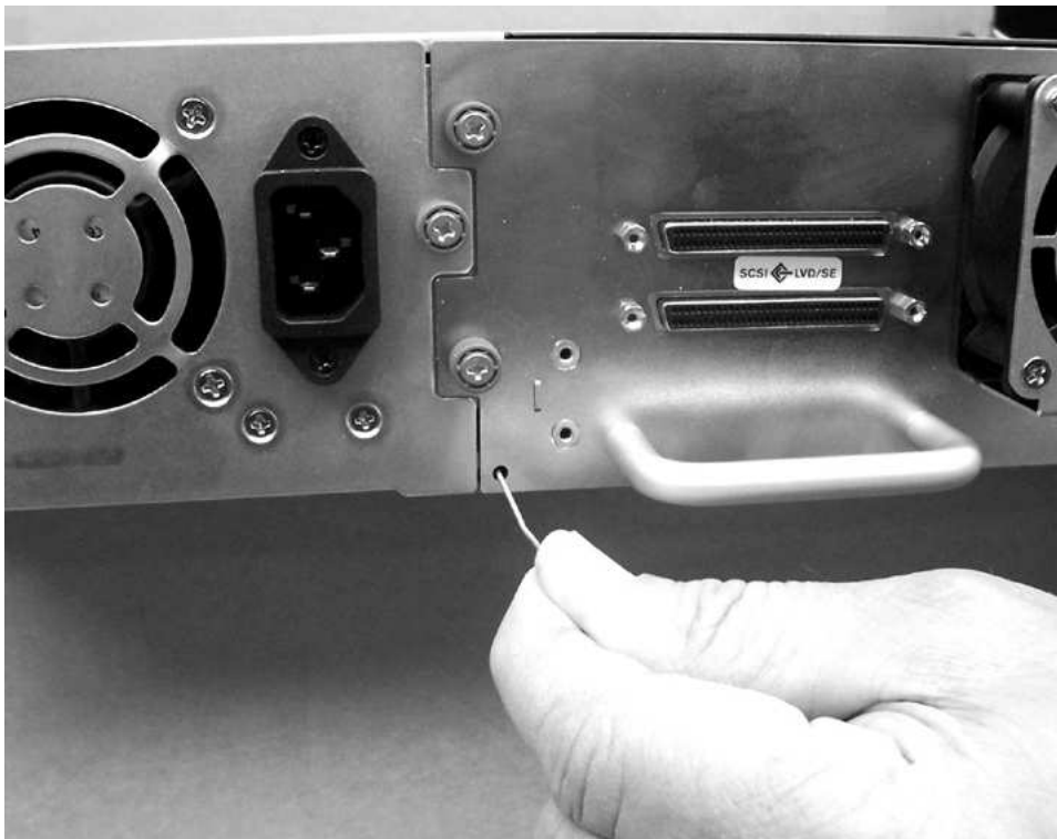
Figura 156. Orificio de acceso del cargador izquierdo (parte posterior de la biblioteca)
