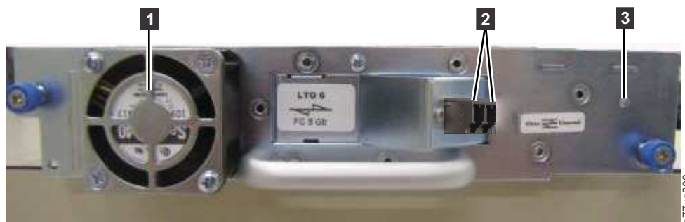
Figura 3. Panel posterior (solo plataforma de unidad) de una unidad de canal de fibra de media altura
