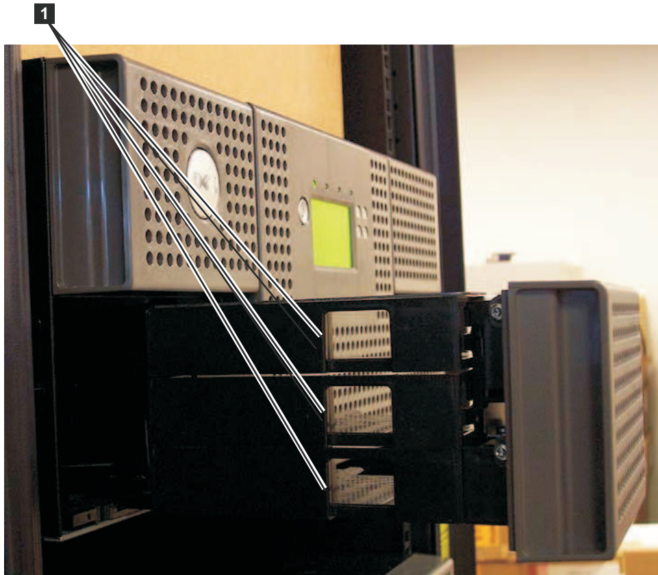
Figura 63. Orificios del grosor de un dedo en la parte posterior de la estación de E/S de la biblioteca de 4U
