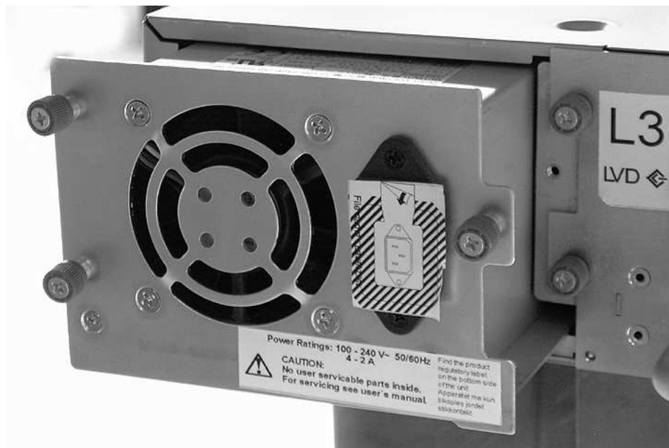
Figura 145. Extracción de una fuente de alimentación de la biblioteca de 2U
