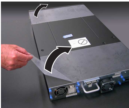
Figura 19. Extracción de las láminas protectoras de plástico de la biblioteca
