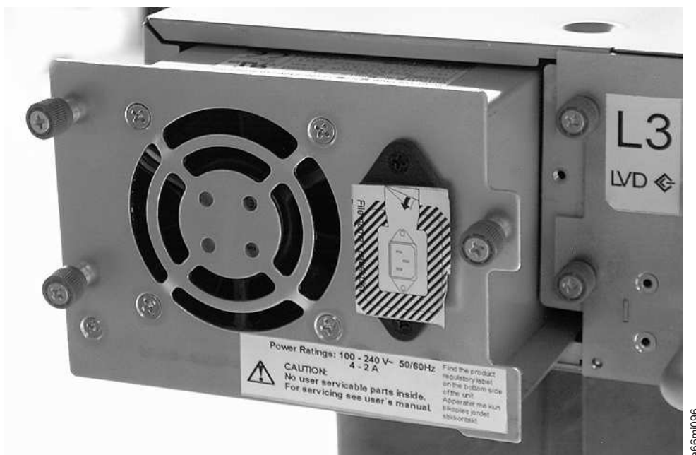
Abbildung 153. Netzteil beim Ausbau aus einem Kassettenarchiv
