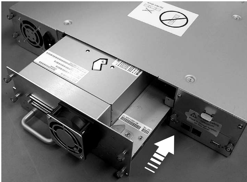
Abbildung 143. Laufwerkschlitten in das Kassettenarchiv schieben (Laufwerkschlitten ohne ESD-Federn abgebildet)
