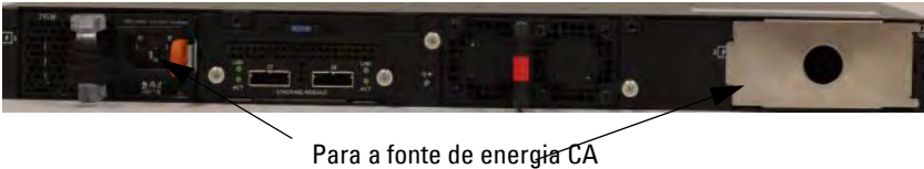
Figura 1-9. Duas fontes de alimentação redundantes no N3132PX-ON
