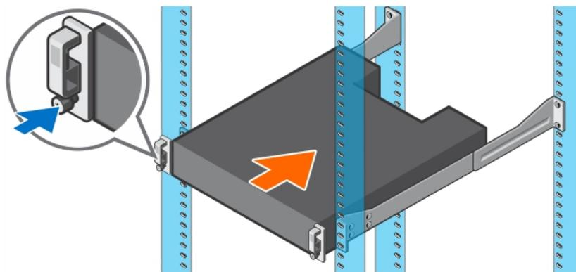
Abbildung 1. Installation des Systems in einem Rack
