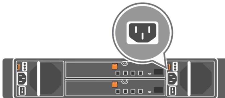
Abbildung 2. Stromkabel anschließen
