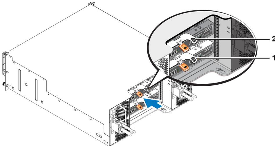
4. Drehen Sie den Hebel nach innen, wodurch der Controller vollständig in den Steckplatz hineingezogen wird. Der Riegel des Hebels rastet an der vorgesehenen Stelle ein.
