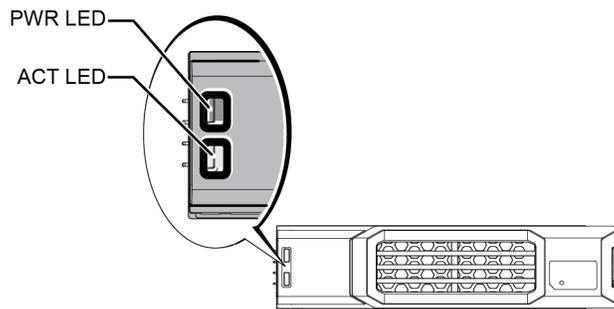
**Abbildung 9: LEDs von 2,5-Zoll-Laufwerken**
