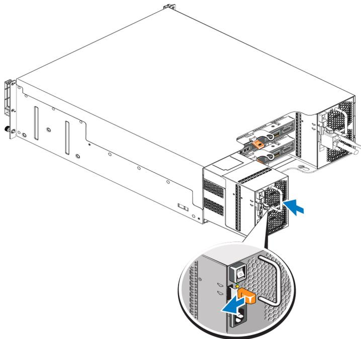
3. Stellen Sie sicher, dass sich der Netzschalter in der Stellung „OFF“ (AUS) befindet.
