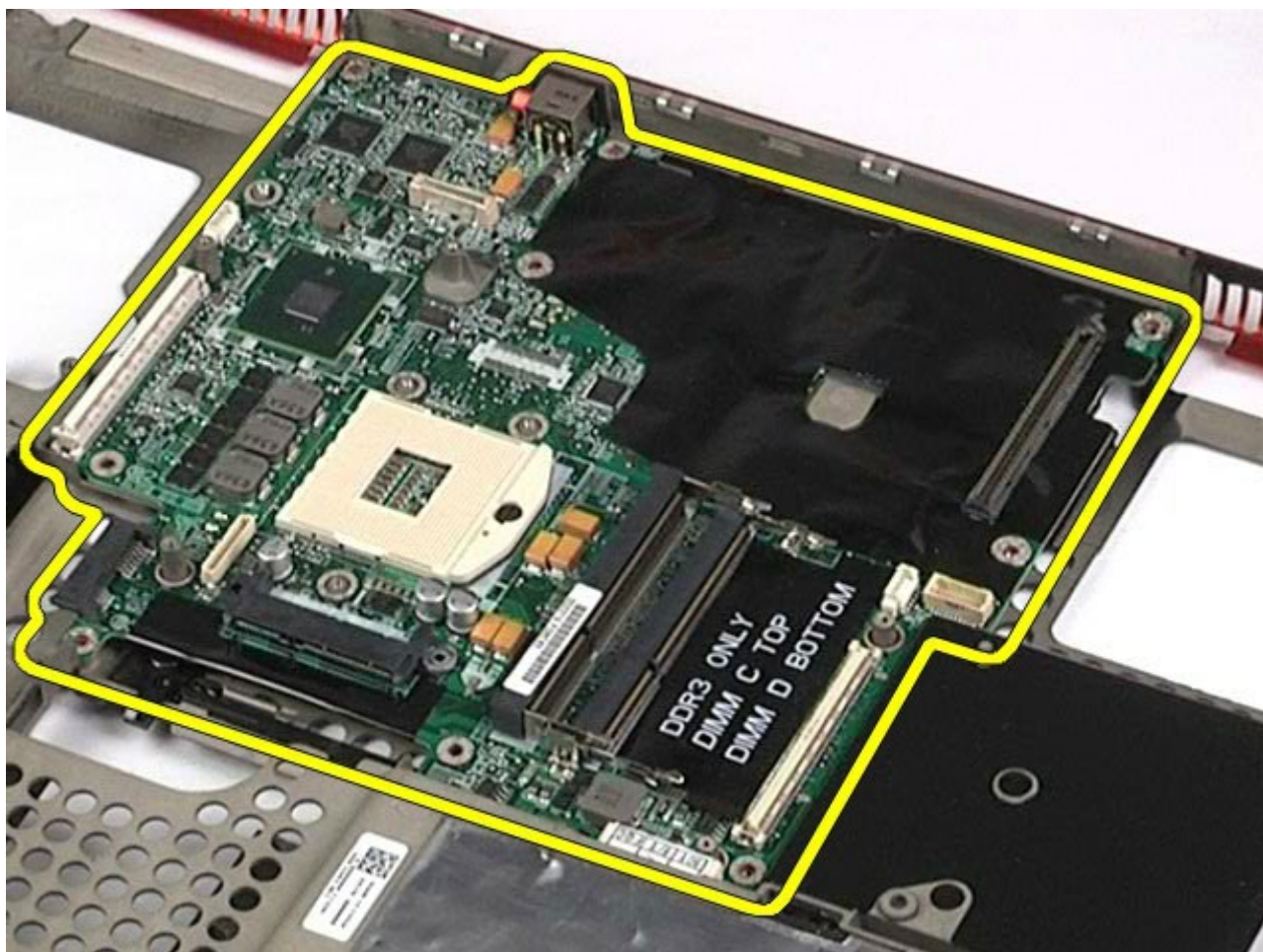
29. Ta bort moderkortet från datorn.
