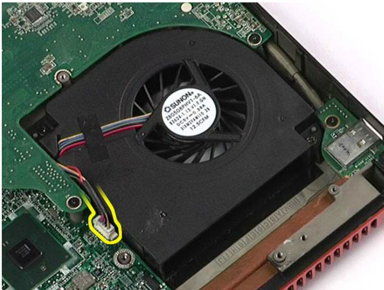
12. Ta bort de skruvar som håller fast fläkten i datorn.
