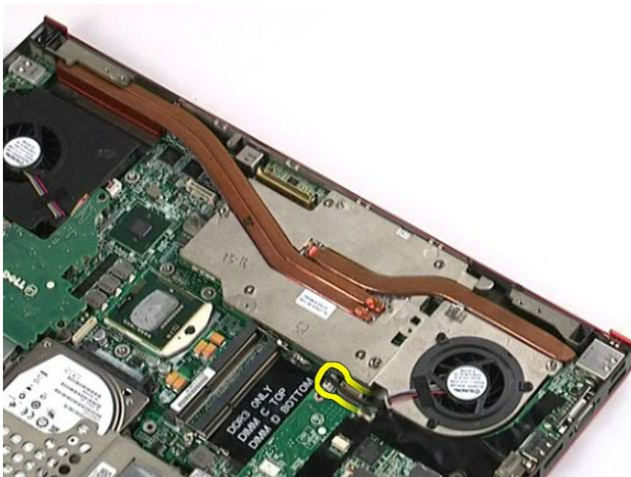
11. Lossa fästskruvarna som håller fast bildskärmskortenheten i datorn.
