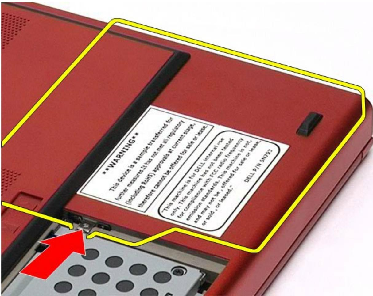
5. Выдвиньте оптический дисковод из его отсека и извлеките из компьютера.
