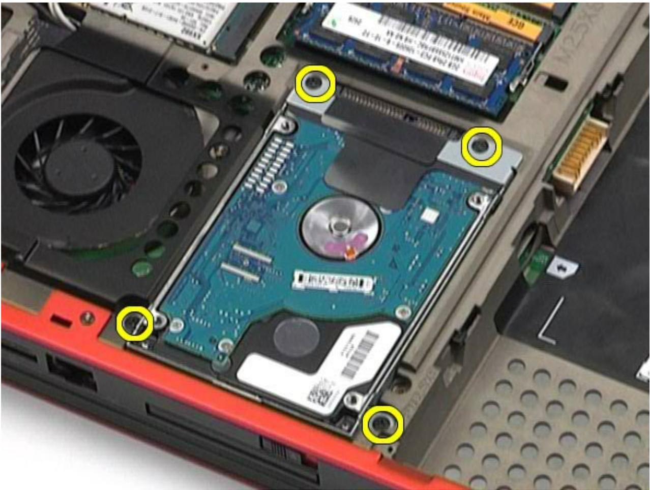
5. Потяните за черный язычок, чтобы приподнять жесткий диск и извлечь его из компьютера.
