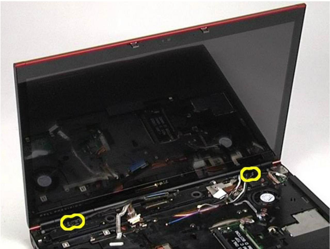
16. Снимите с компьютера дисплей в сборе.
