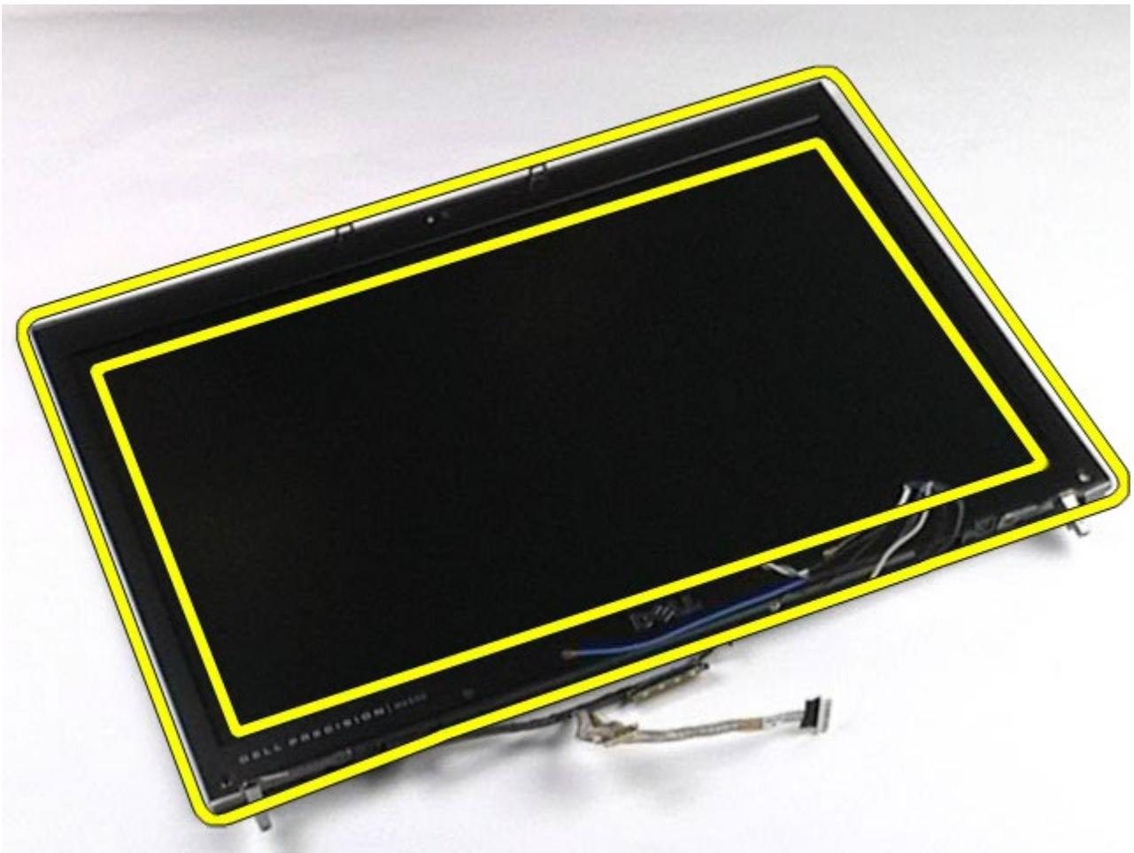
10. Снимите лицевую панель дисплея с панели дисплея.
