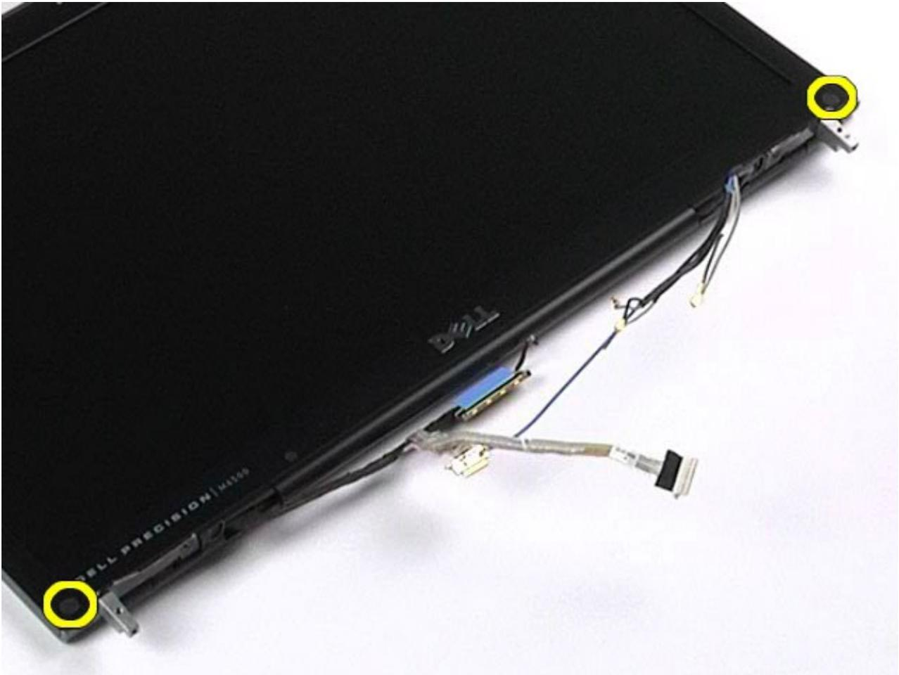
8. Выверните винты, которыми лицевая панель дисплея панели дисплея.
