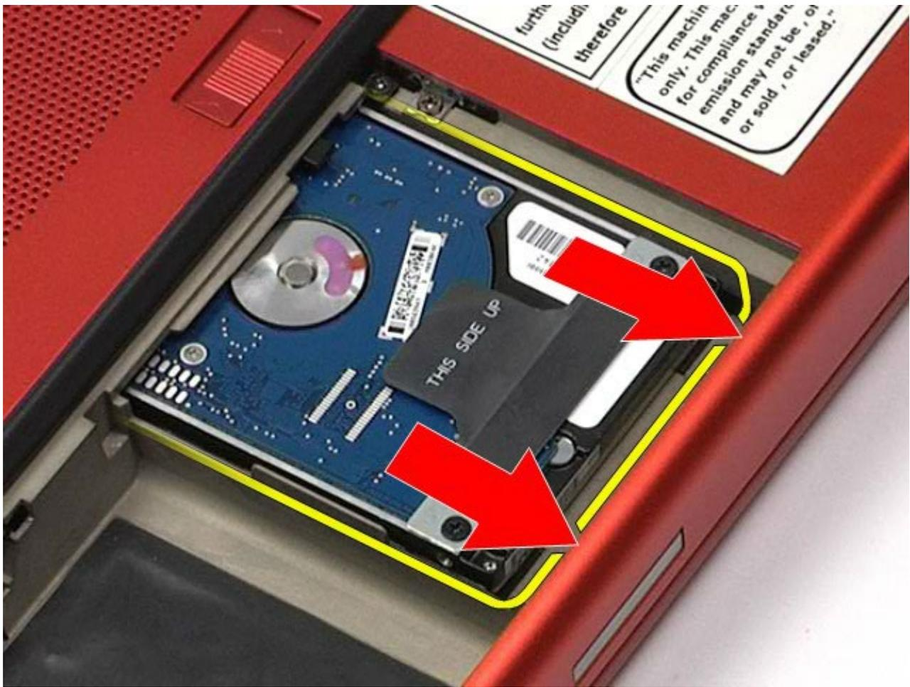
7. С помощью черного язычка приподнимите жесткий диск и извлеките его из компьютера.
