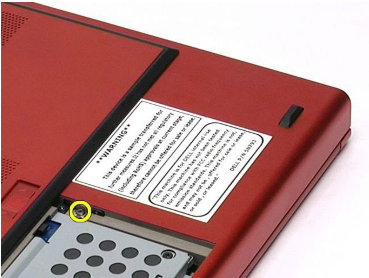
4. Отверткой или небольшой пластиковой палочкой подтолкните оптический дисковод к внешнему краю компьютера.
