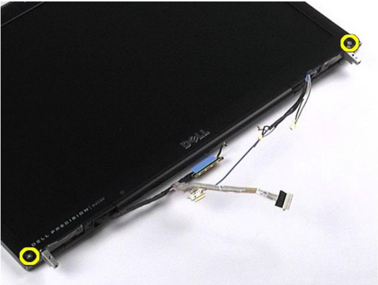
9. Осторожно отделите лицевую панель дисплея от панели дисплея, перемещая пальцы между краем лицевой панели и панелью дисплея.
