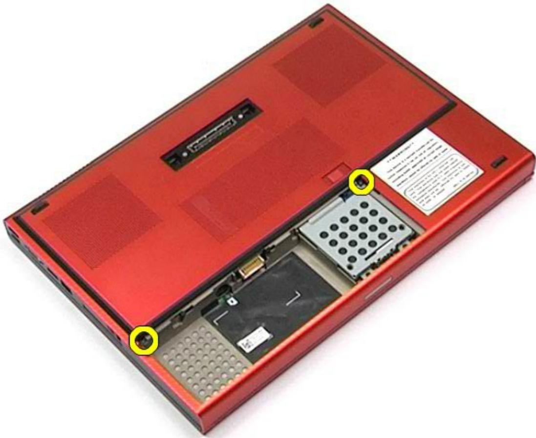
4. Сдвиньте съемную панель по направлению к отсеку аккумулятора.
