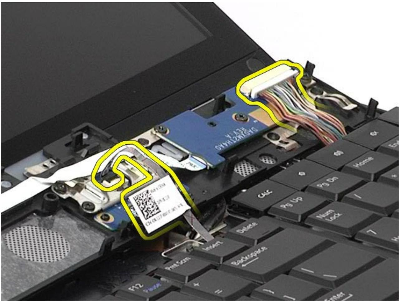
6. Снимите с компьютера крышку шарнира.
