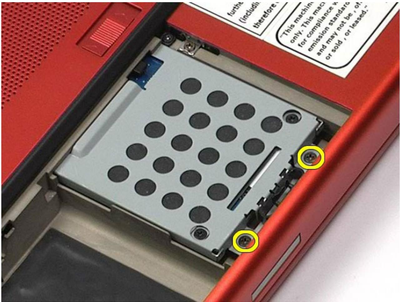
4. Потяните фиксатор, чтобы высвободить каркас накопителя.
