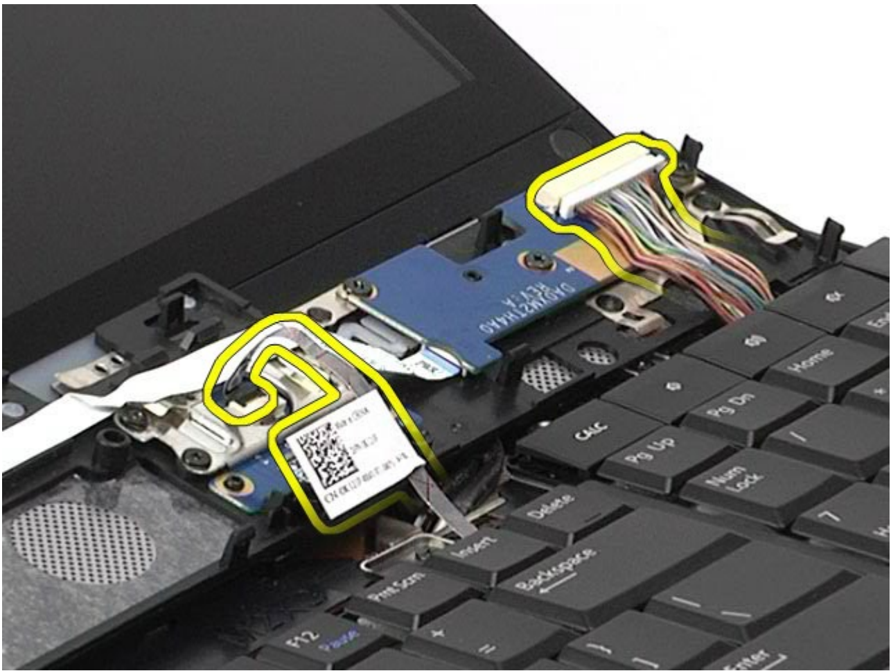
6. Ta hengseldekslet av datamaskinen.
