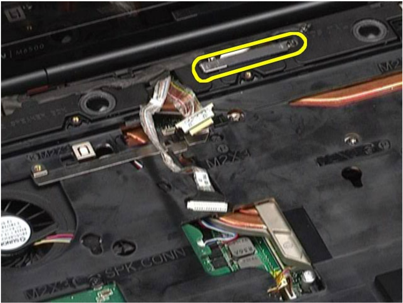
13. Koble skjermkabelen fra kontakten på datamaskinen.
