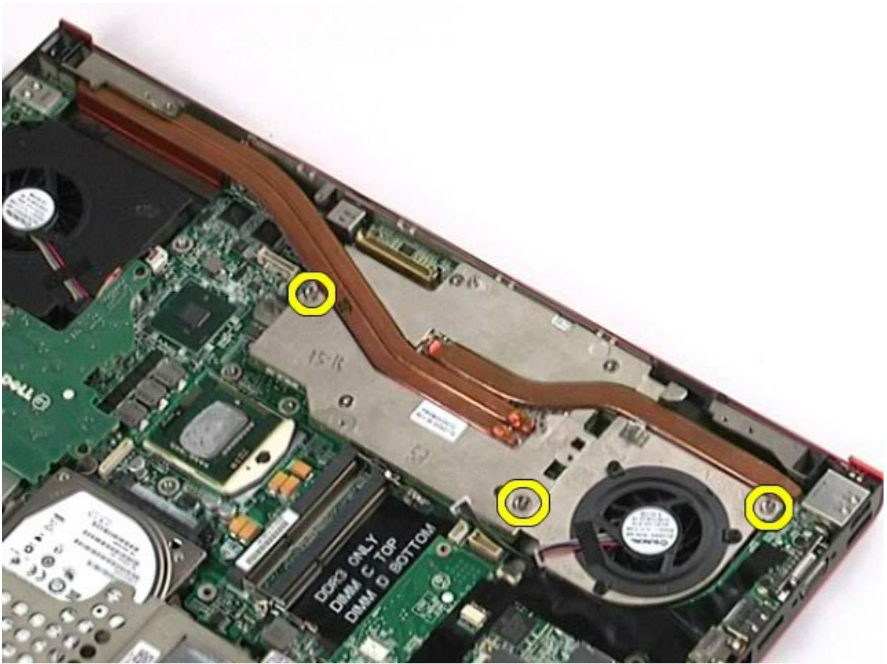
12. Ta ut skjermkortenheden fra datamaskinen.
