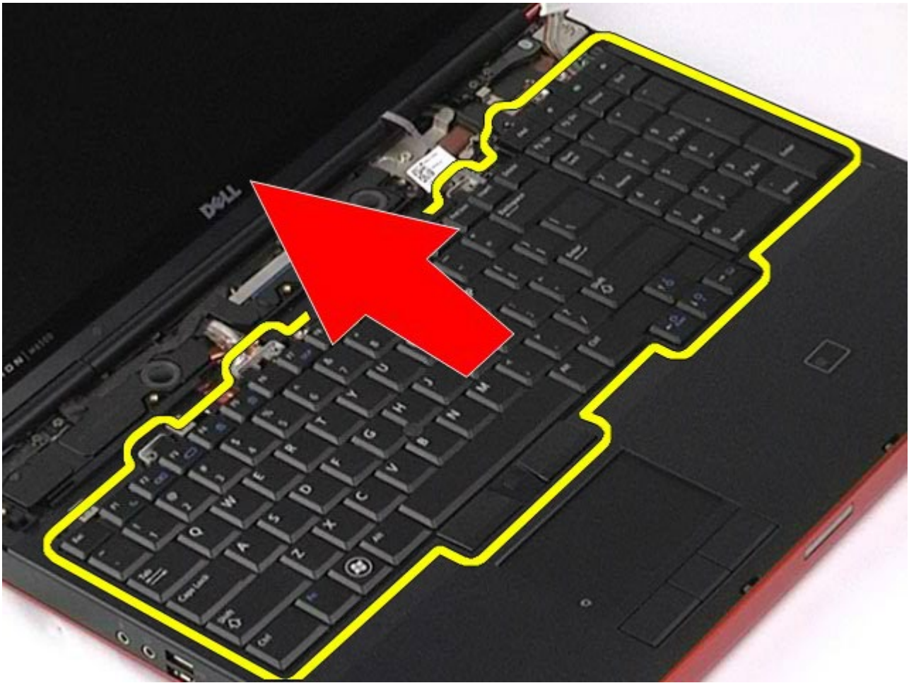
6. Ta tastaturet av datamaskinen.
