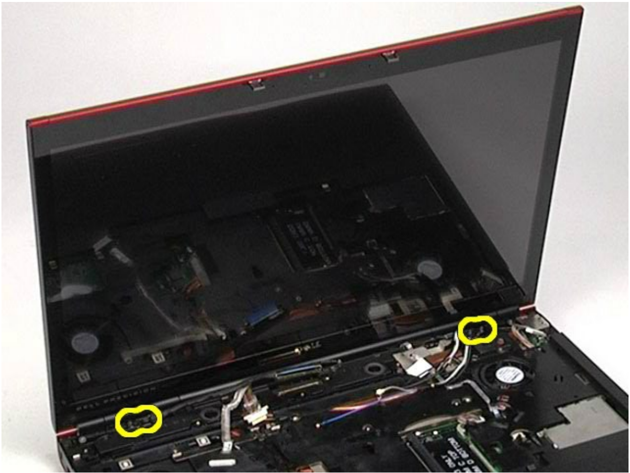
16. Ta skjermenheten av datamaskinen.
