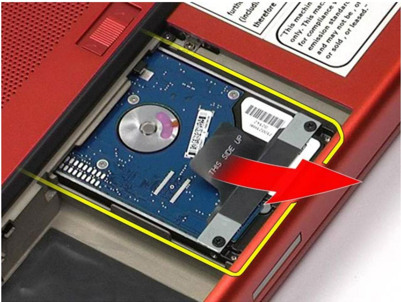
8. Lepaskan baut yang menahan bar tab penarik hitam ke hard drive.
