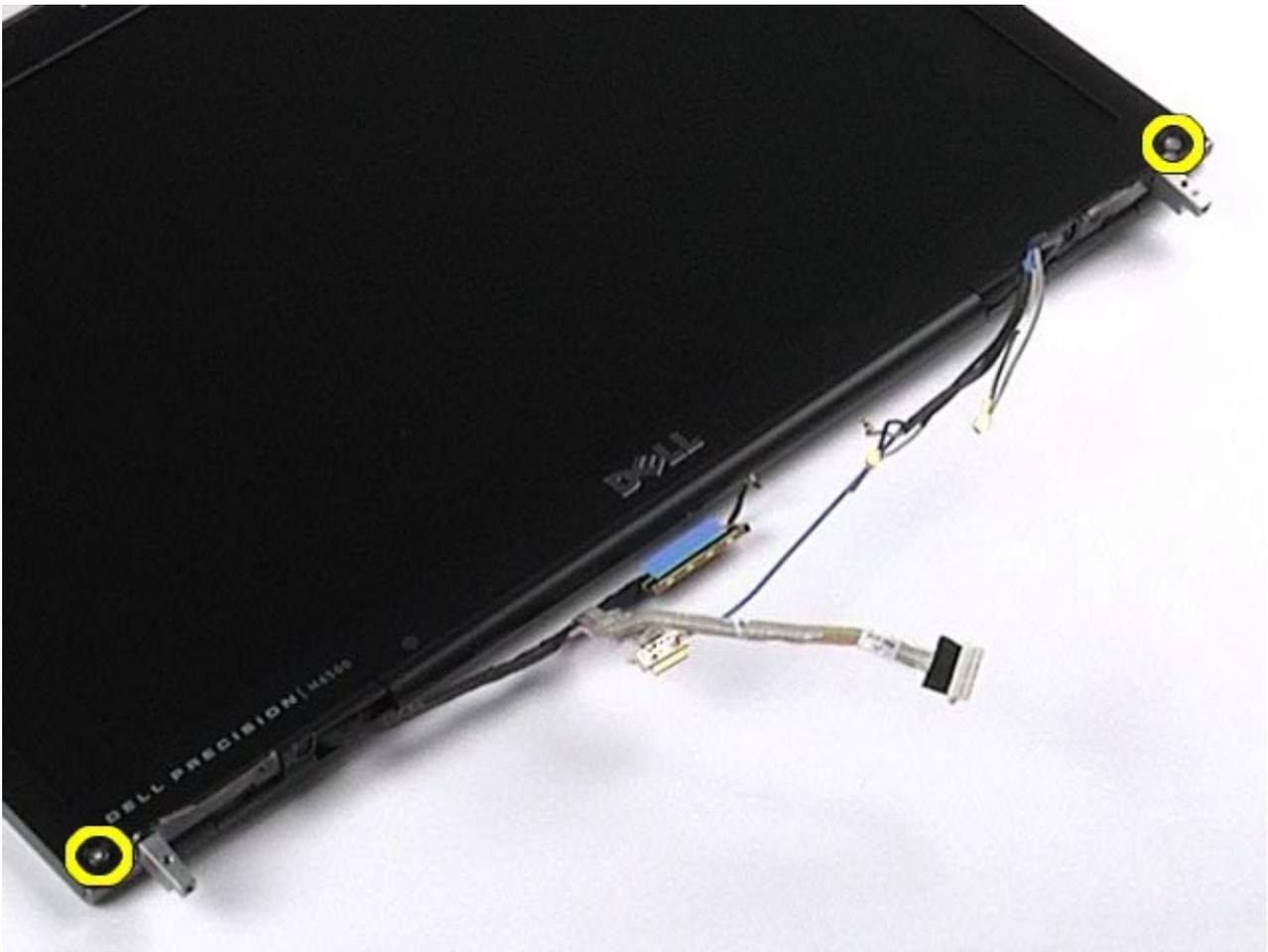
9. Cungkil perlahan bezel display dari panel display dengan memasukkan jari-jari Anda di antara tepi bezel dan panel display.
