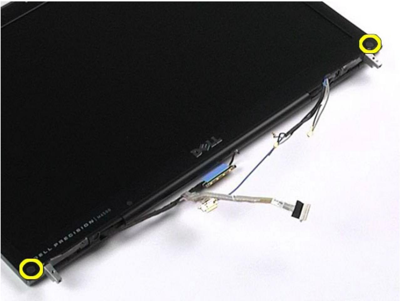
8. Lepaskan baut yang menahan bezel display ke panel display.
