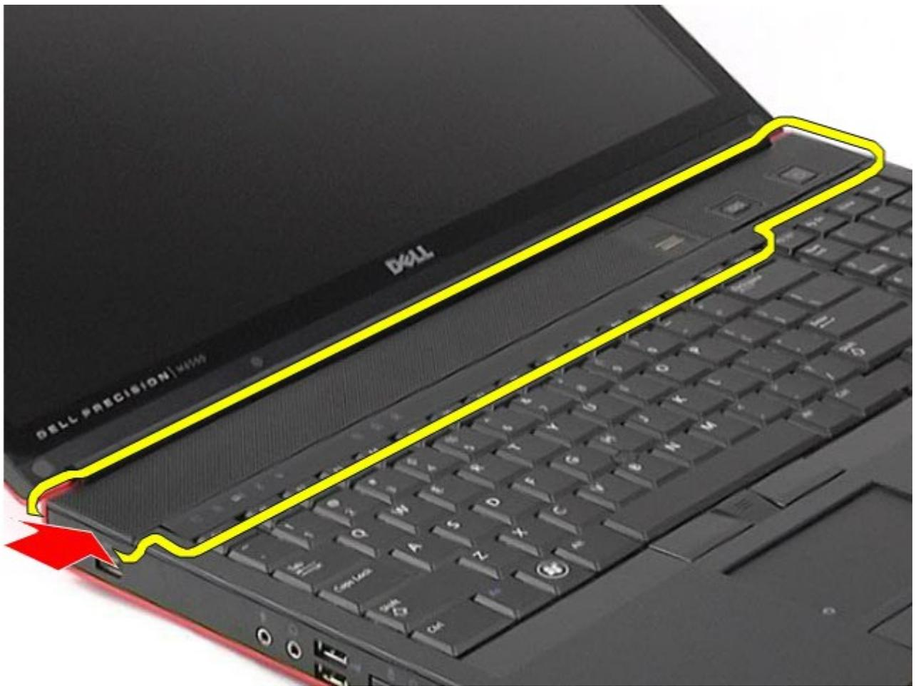
4. Balikkan penutup engsel dan lepaskan dari penutup pada keyboard.
