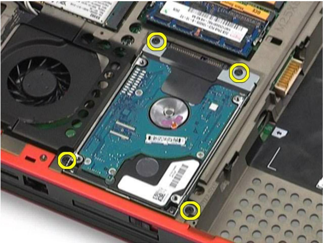
5. Tarik tab hitam untuk mengangkat hard drive ke atas dan lepaskan dari komputer.
