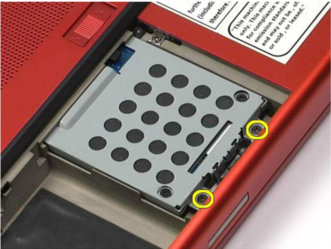
4. Tarik tab pelepas untuk melepaskan rangka hard-drive dari komputer.
