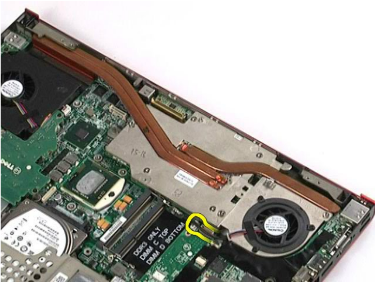
11. שחרר את הברגים התפוסים שמחברים את מכלול כרטיס הווידאו למחשב.
