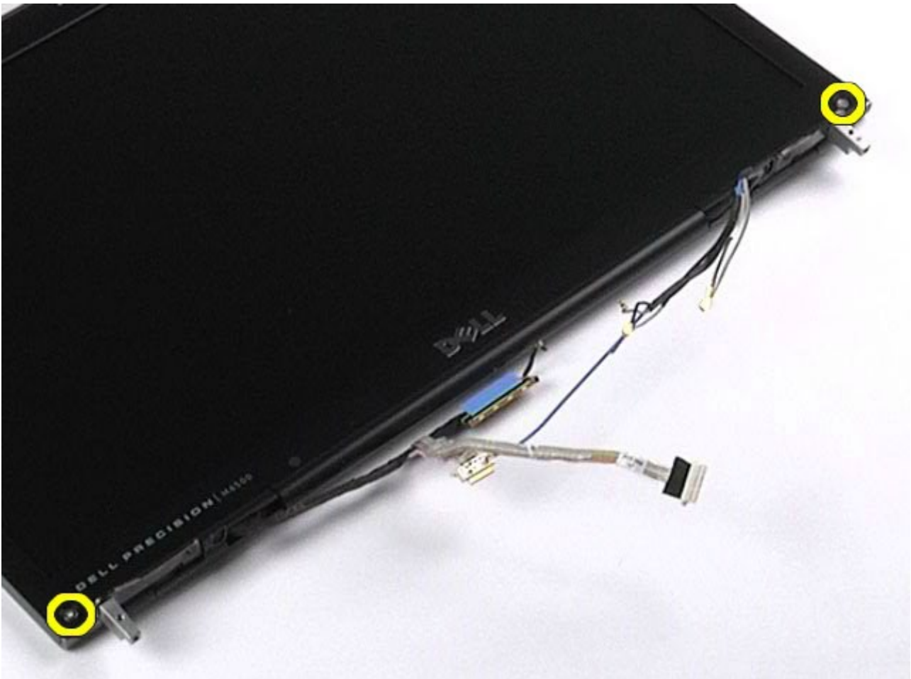
9. הוצא בעדינות את הלוח הקדמי של הצג מלוח התצוגה. לשם כך, גלגל את אצבעותיך בין קצה הלוח הקדמי לבין לוח התצוגה.
