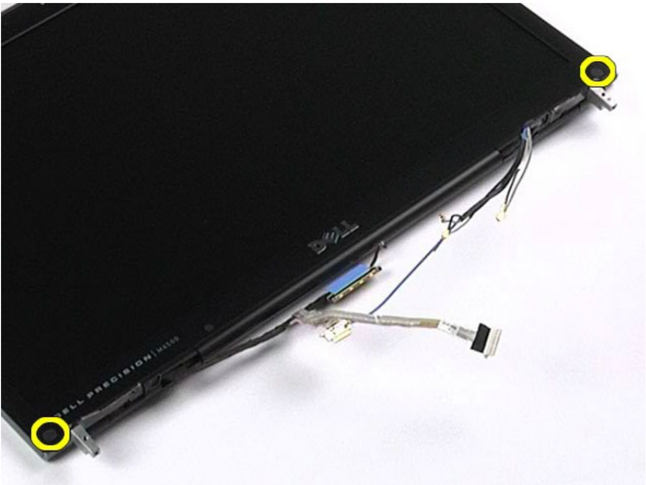
8. הסר את הברגים המקבעים את הלוח הקדמי של הצג אל לוח התצוגה.
