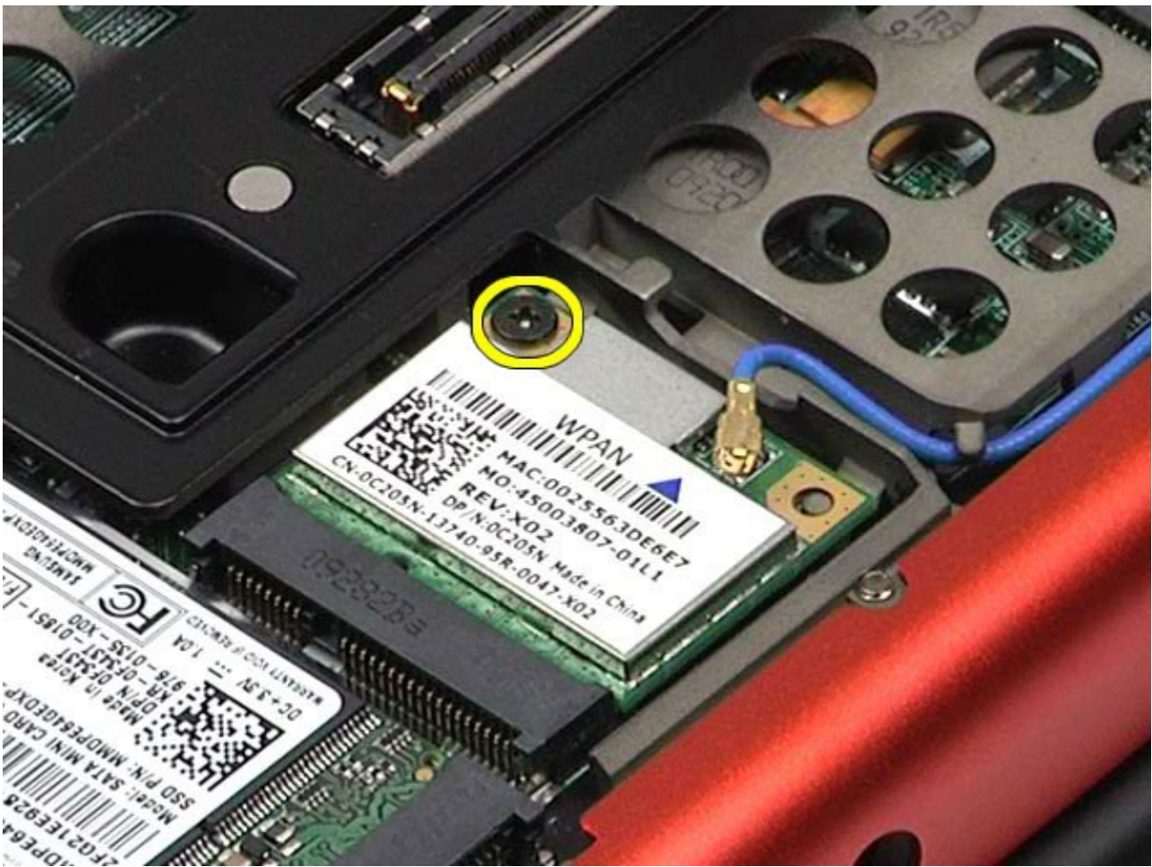
6. החלק את כרטיס ה-WPAN החוצה מתוך המחבר בלוח המערכת.
