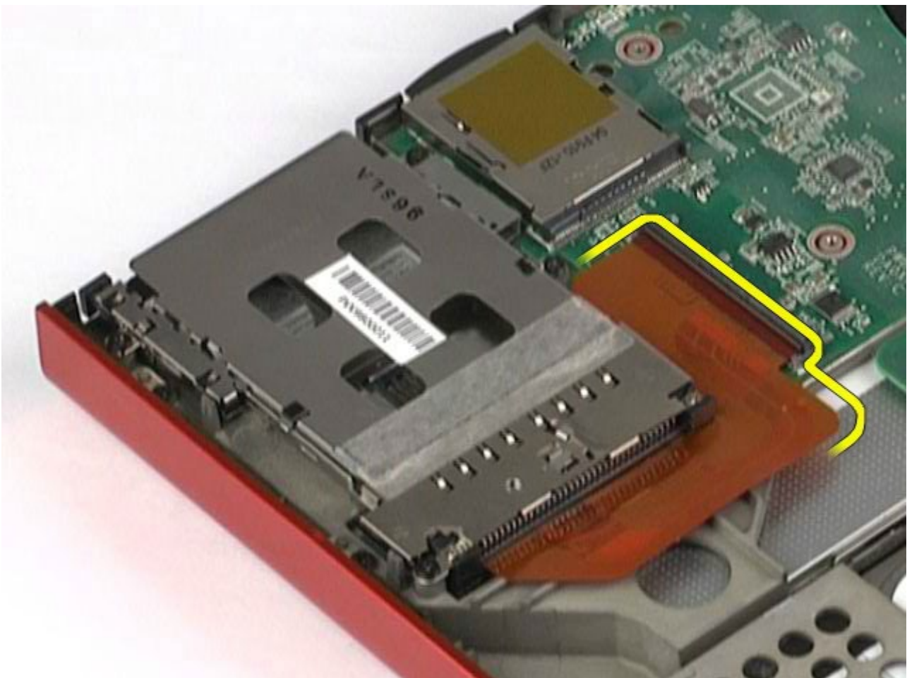
12. הסר את הברגים המחוברים את תא הכרטיס אל המחשב.
