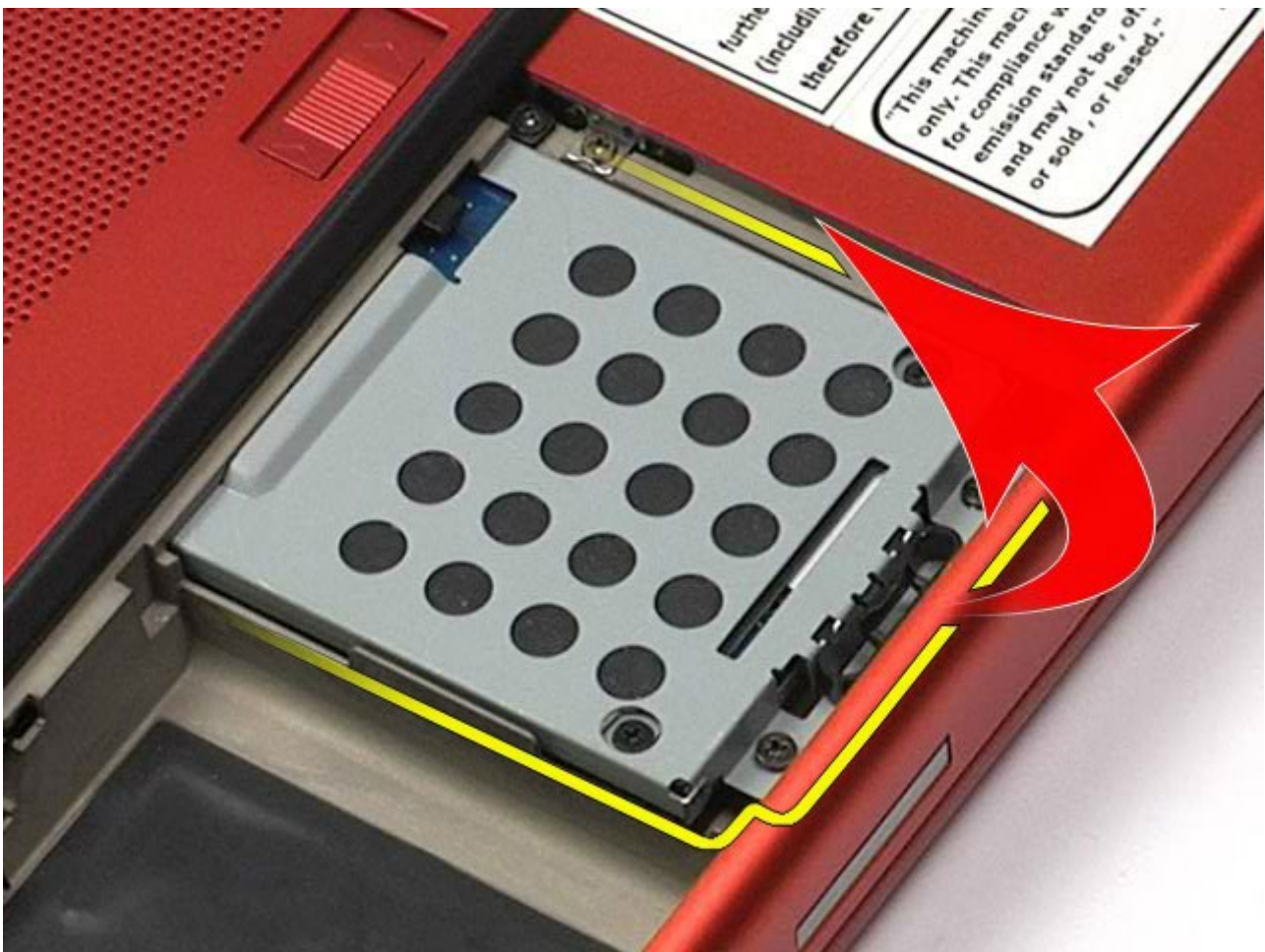
5. הסר את מעטפת ההארקה/סיכוך של הכונן הקשיח מהמחשב.
