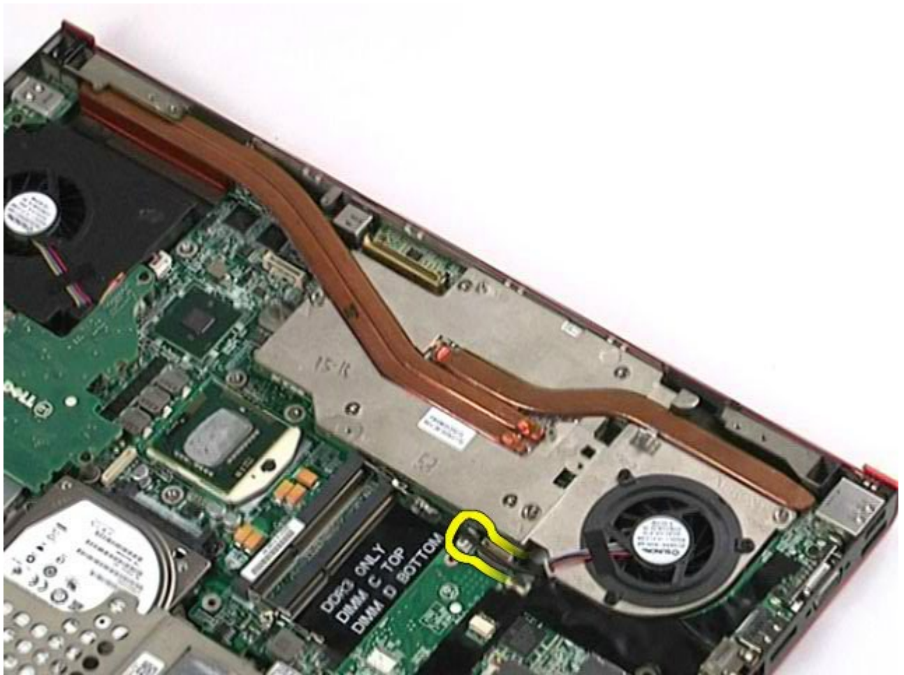
11. Löysää lukkoruuvit, joilla näyttöohjainyksikkö on kiinnitetty tietokoneeseen.
