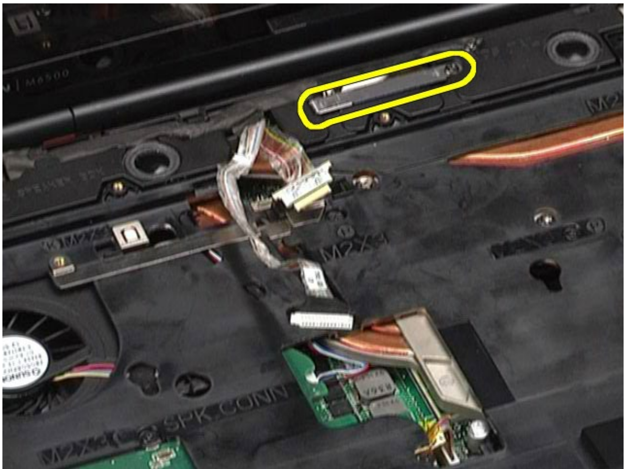
13. Irrota näyttökaapeli tietokoneen liittimestä.
