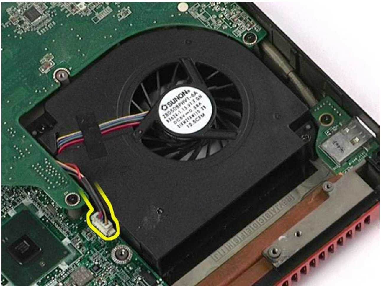
12. Irrota ruuvit, joilla tuuletin on kiinnitetty tietokoneeseen.
