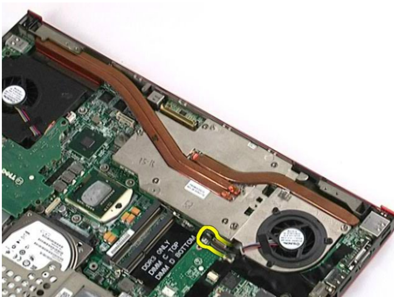
11. Løsn de skruer, der fastgør skærmkortmodulet til computeren.
