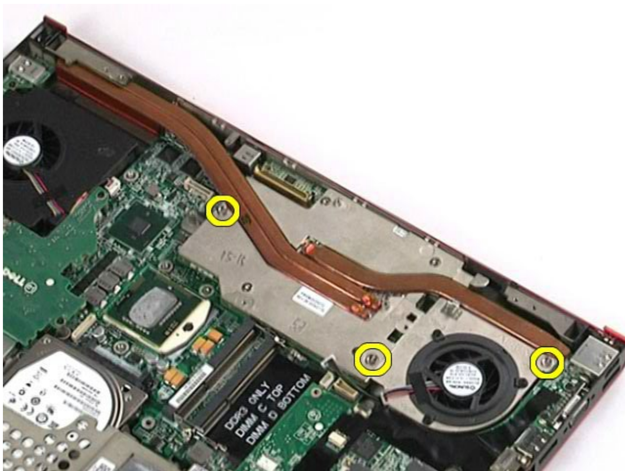
12. Fjern skærmkortmodulet fra computeren.
