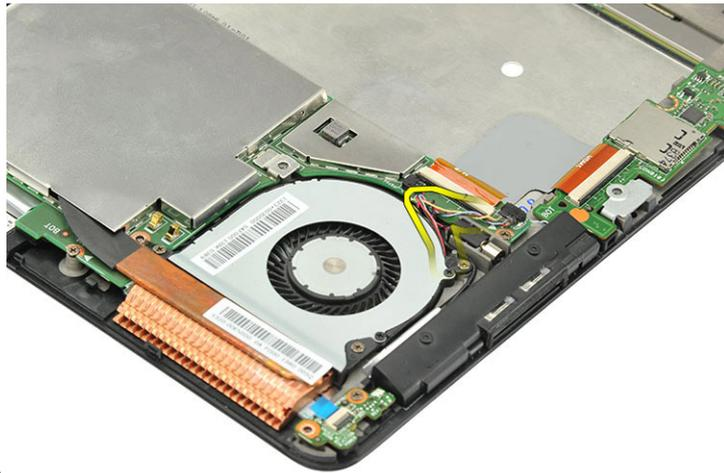
3. Lift up the thermal fan cable.
