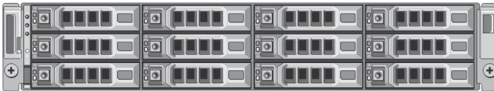
그림 2 . DR4100 System Expansion Shelf (MD1200) Drive Slot Locations
