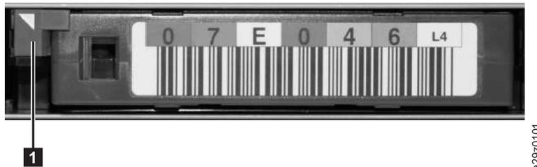
Figure 45. Taquet de verrouillage des cartouches
