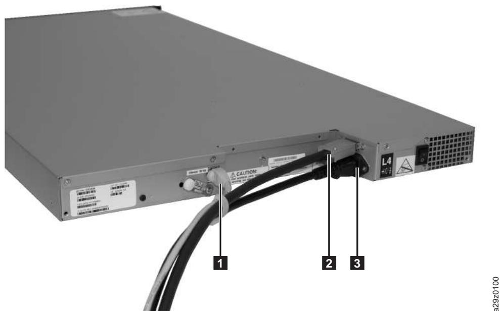
Figure 28. Branchement du câble d'interface
