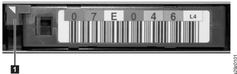
Abbildung 45. Kassettenentriegelungshebel
