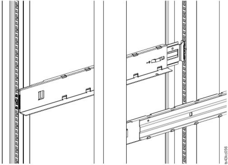
图 39. 已安装侧面导轨
