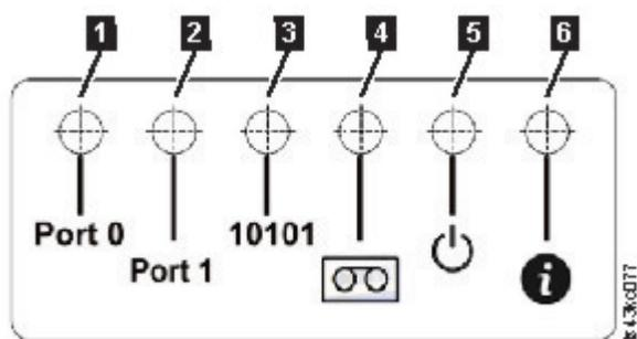
图 18. 磁带机箱指示灯
