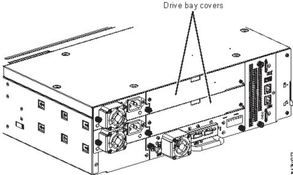
图 58. 磁带机托架外盖
