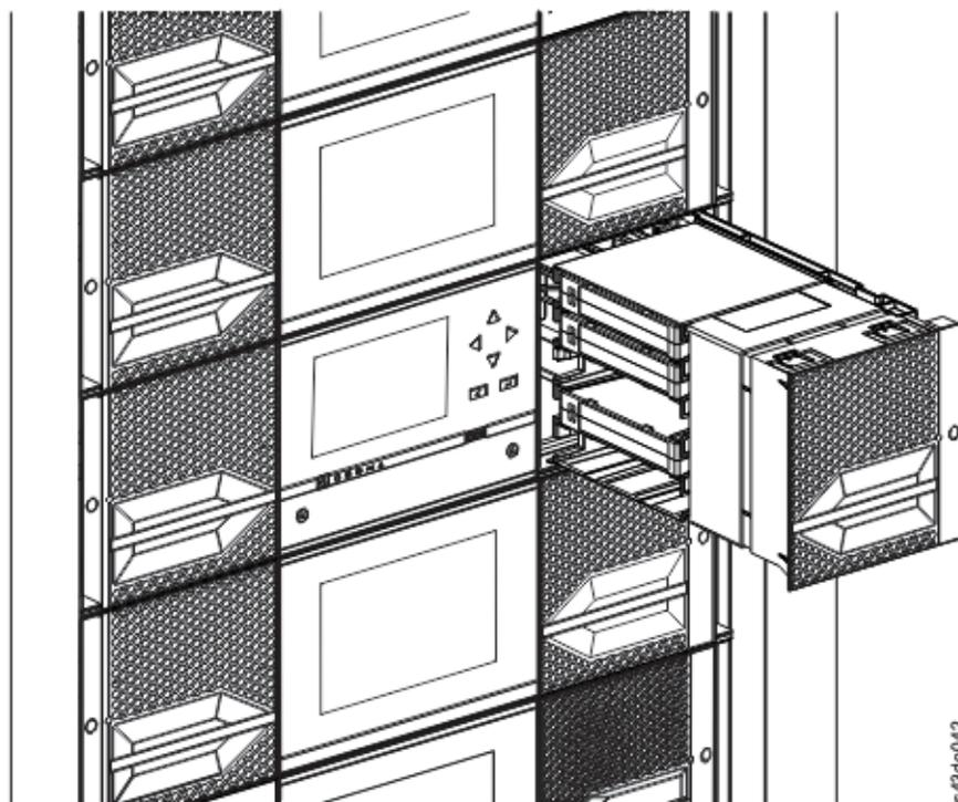
图 53. 拔出的磁带匣
