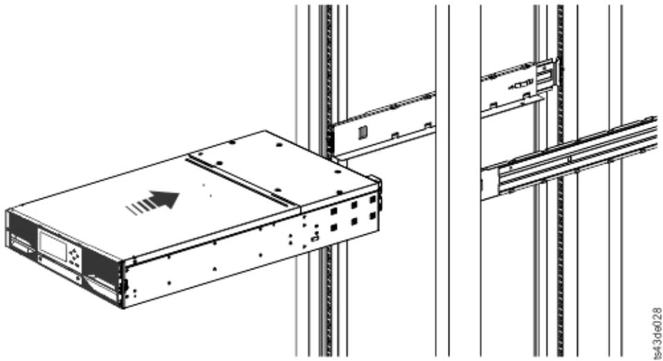
图 40. 将磁带库滑入机架
