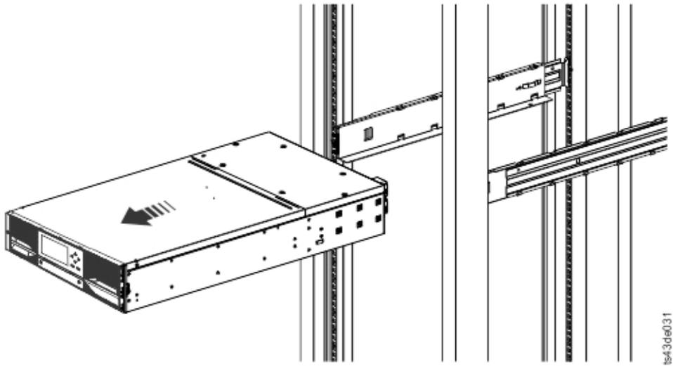
图 65. 将模块从机架中滑出
