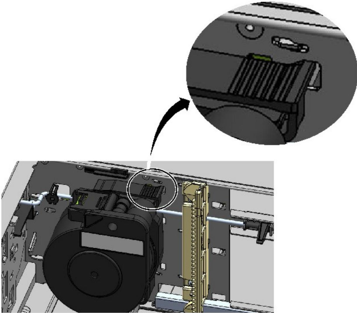
图 80. 解锁的电缆盘装置 - 放大视图
