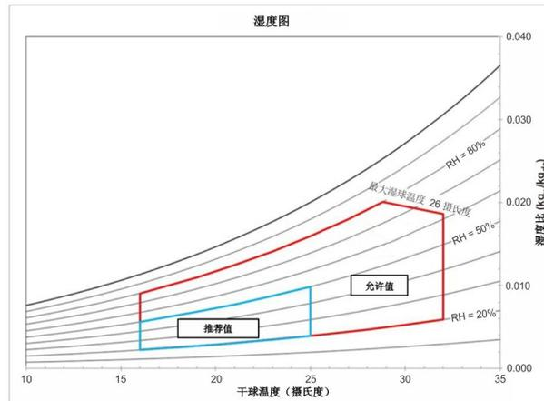
图 23. 湿度图显示针对磁带库推荐和允许的操作环境
