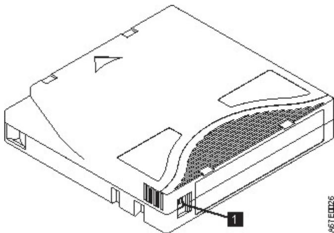
图 88. 设置写保护开关
