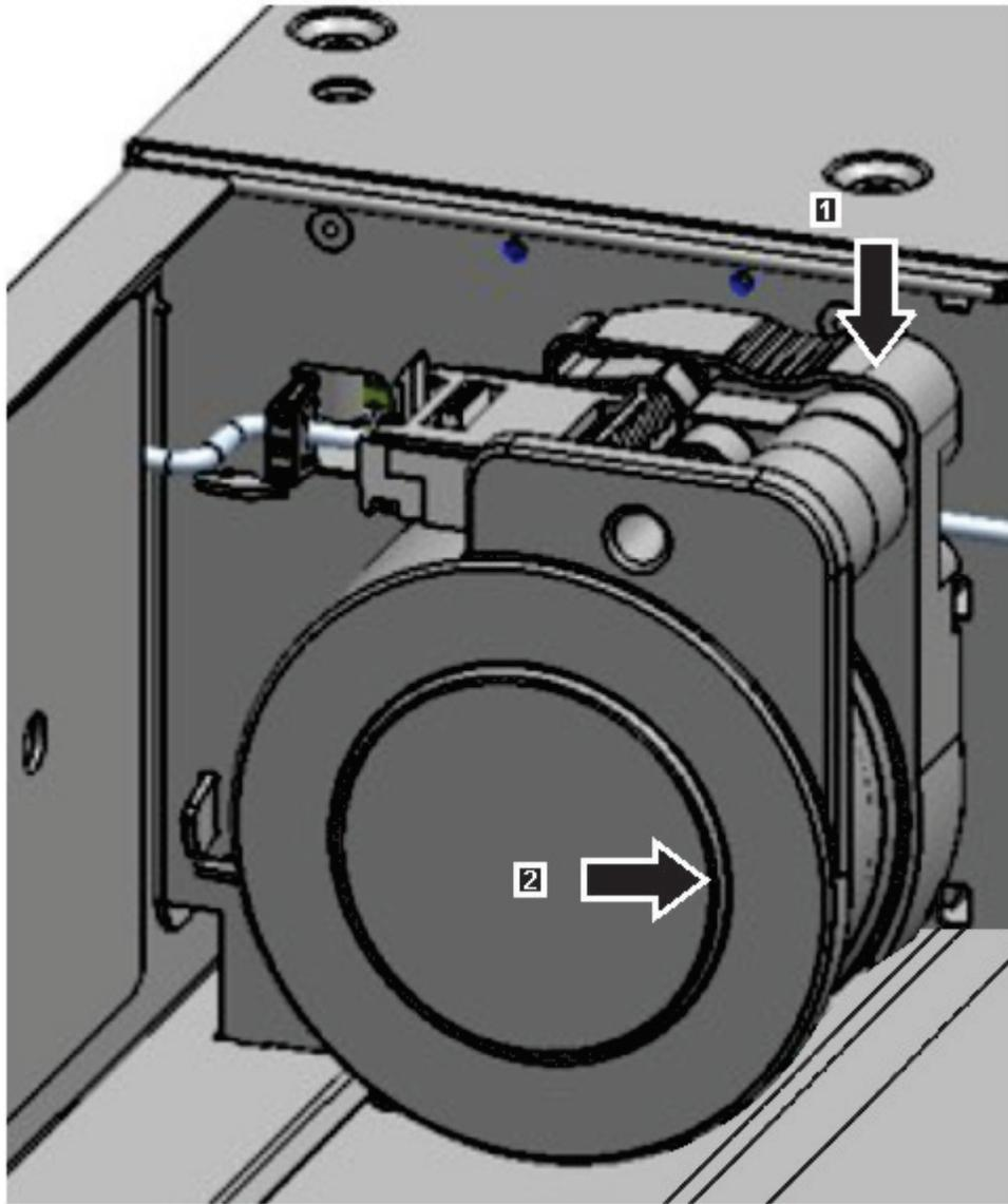
图 79. 解锁电缆盘装置
