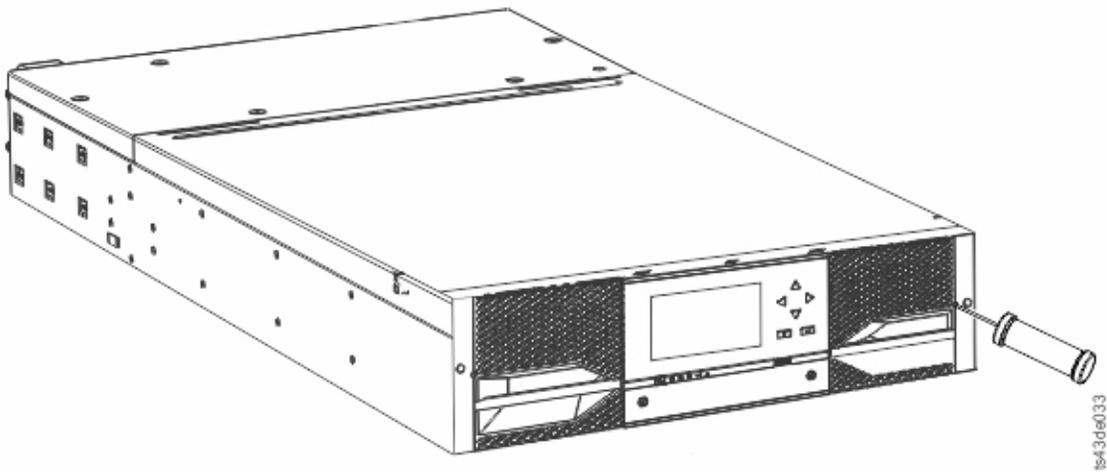
图 83. 手动释放右侧磁带匣
