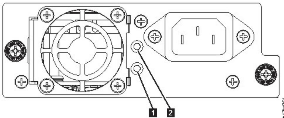
图 16. 电源后面板指示灯
