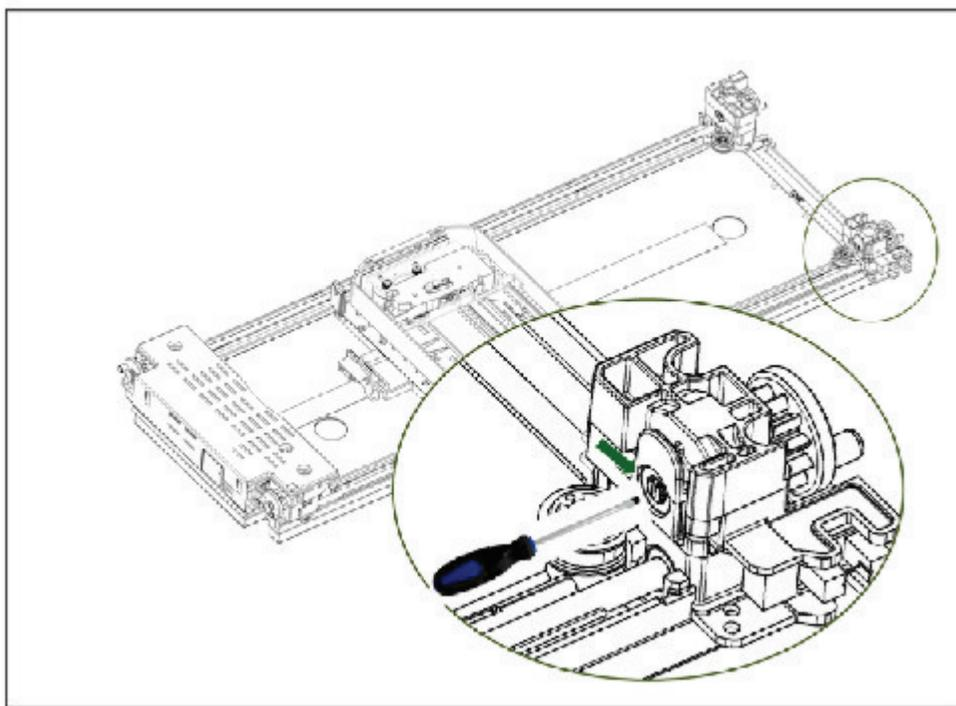
图 77. 插入螺丝刀以手动操作存取器
