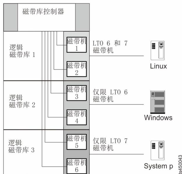
图 17. 在逻辑磁带库中混用磁带机
