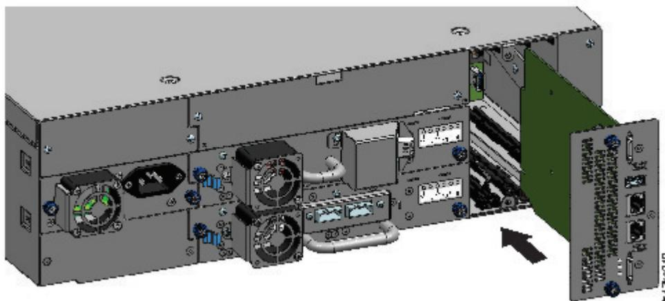
图 69. 安装控制器卡
