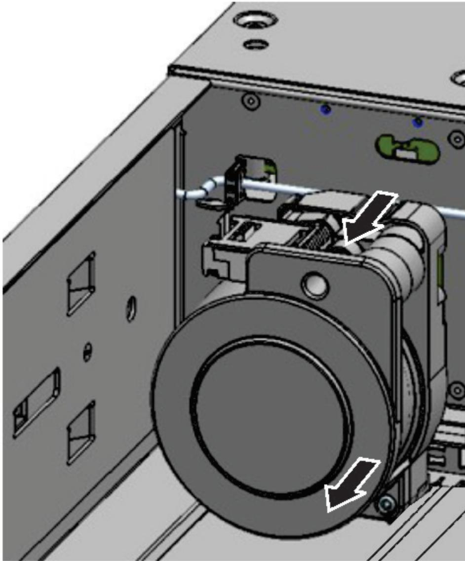
图 82. 卸下电缆盘装置
