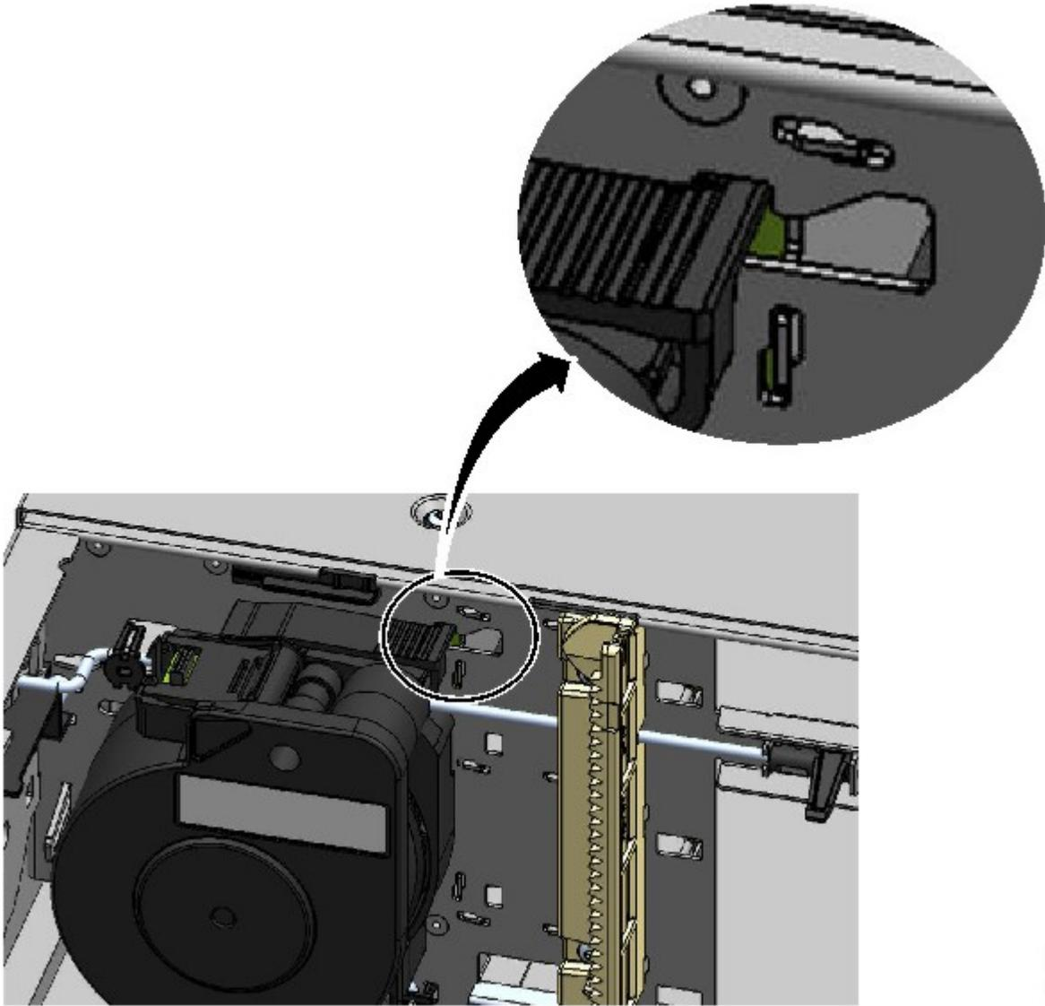
图 81. 锁住的电缆盘装置 - 放大视图
