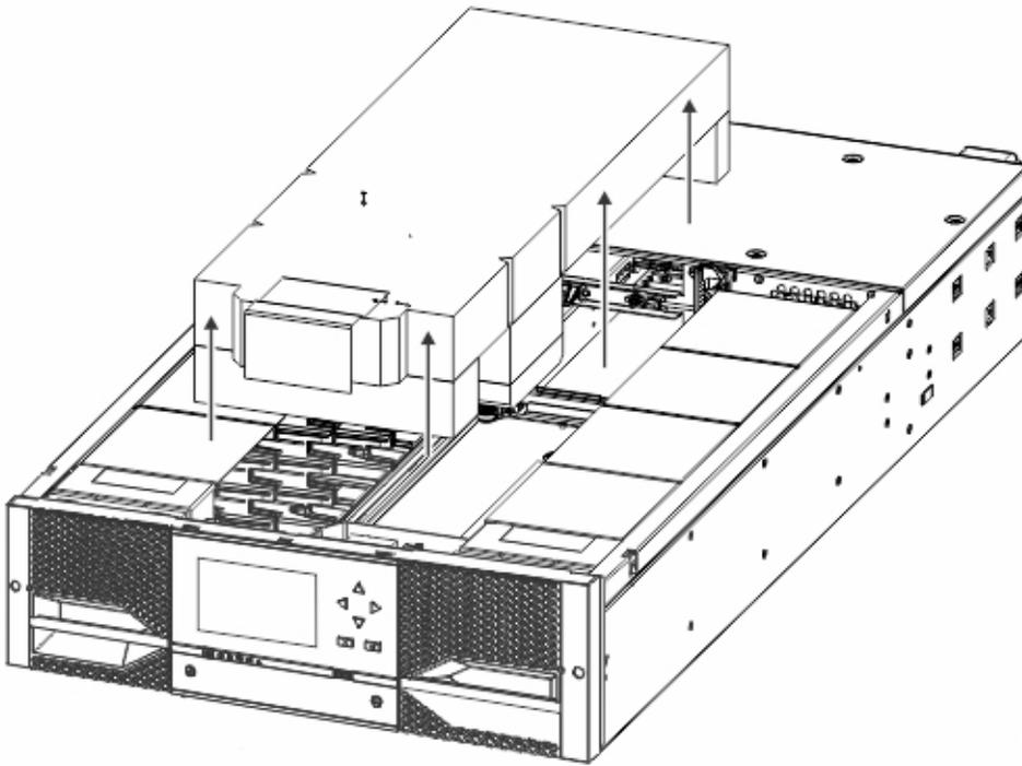
图 30. 卸下填充泡沫，并显示内部组件 - 基本模块。
