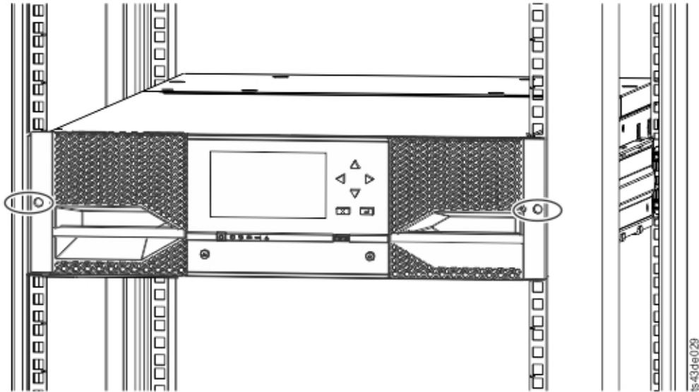
图 64. 拧松翼形螺钉
