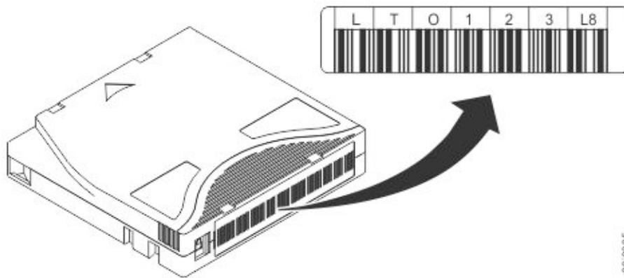
图 87. LTO8 盒式磁带上的条形码标签样本。卷序列号（LTO123）和条形码打印在标签上。
